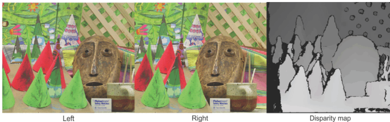
图 12. 来自 Middlebury 数据集的圆锥和面孔。使用简单的 SAD 法进行视差计算。视差在弯曲的表面上保持轻微变化，而在物体边界上剧烈变化。请查看右上角围栏的视差空洞以及左边界其他物体的不连续性和遮挡情况
