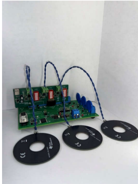
图 1-1. 采用 TIDA-010987 、 ADS131M08MET-EVM 和 TIDA-010986 的三相电表罗氏线圈设计
