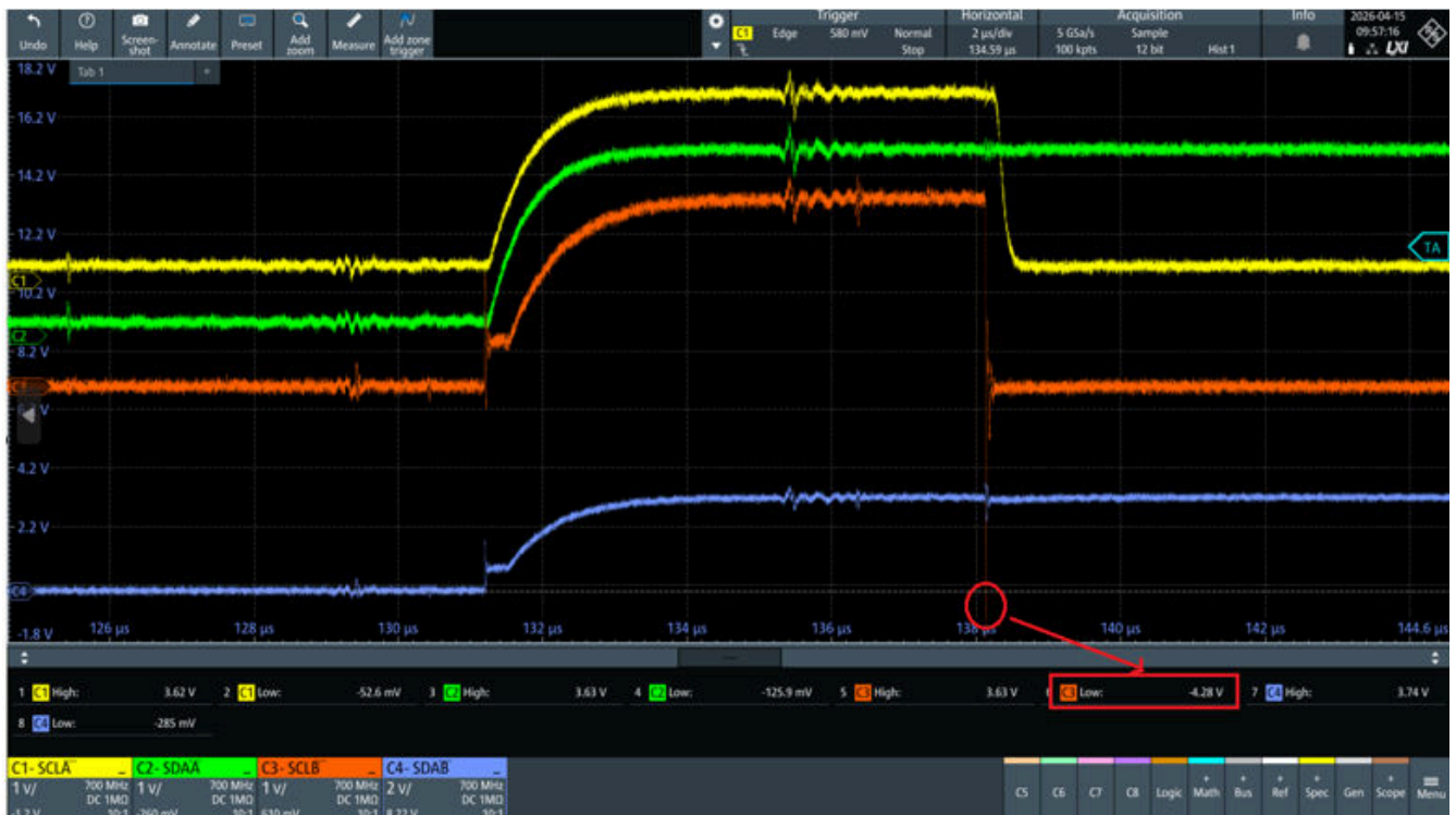
图 2-3. ICT 的下冲尖峰测试
