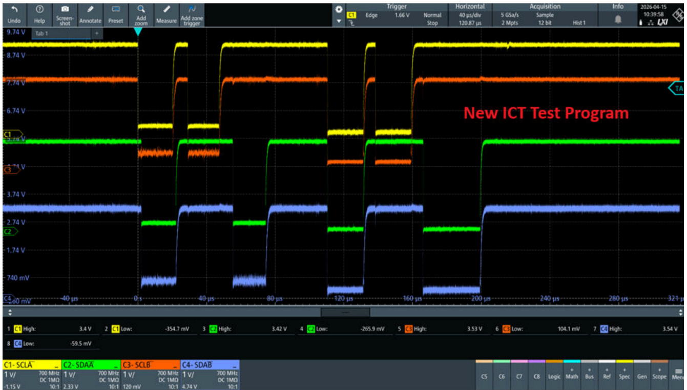
图 2-4. 软件和硬件更改的新 ICT 设置可减少过冲/下冲行为，并解决 B 侧基座争用问题
