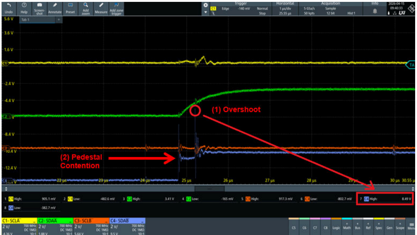
图 2-2. ICT 的过冲尖峰测试
