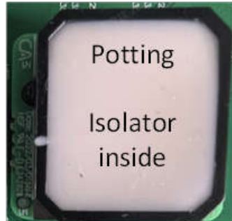
图 5-3. 实现固体绝缘的灌封方法
