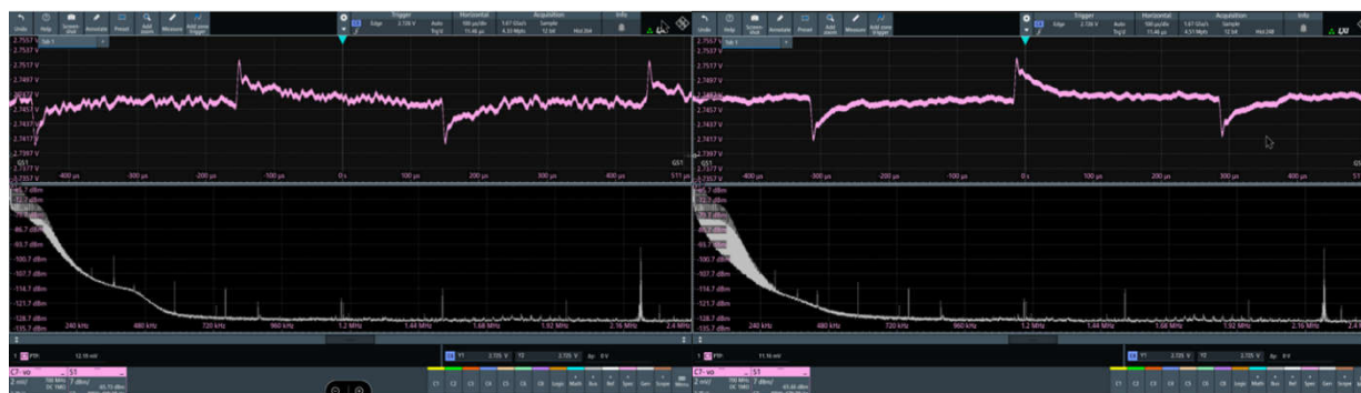
图 3-7. 带与不带前馈电容器时的降压转换器输出电压
