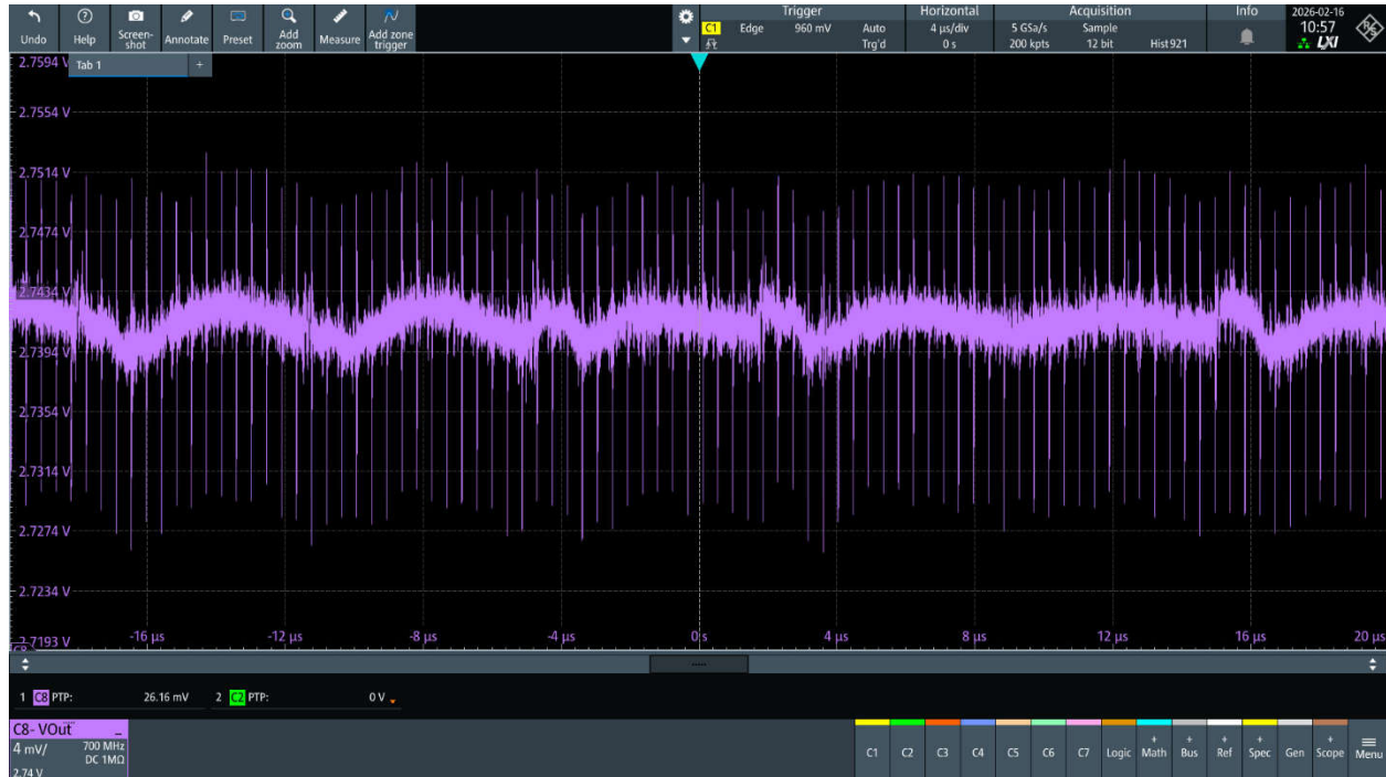
图 3-2. 使用 8cm 长走线时的 TPS62913 输出电压
