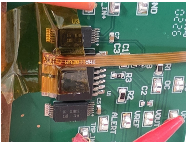
图 3-3. PCB 上的 TMP118 柔性电缆放置位置
