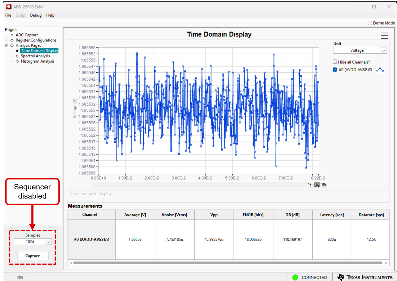
图 4-8. ADS125P08 EVM GUI 时域页面 — 序列发生器已禁用
