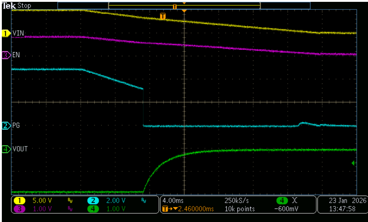
图 3-8. 电源正常置为无效 — EN 通过电阻分压器连接至下降的 VIN
