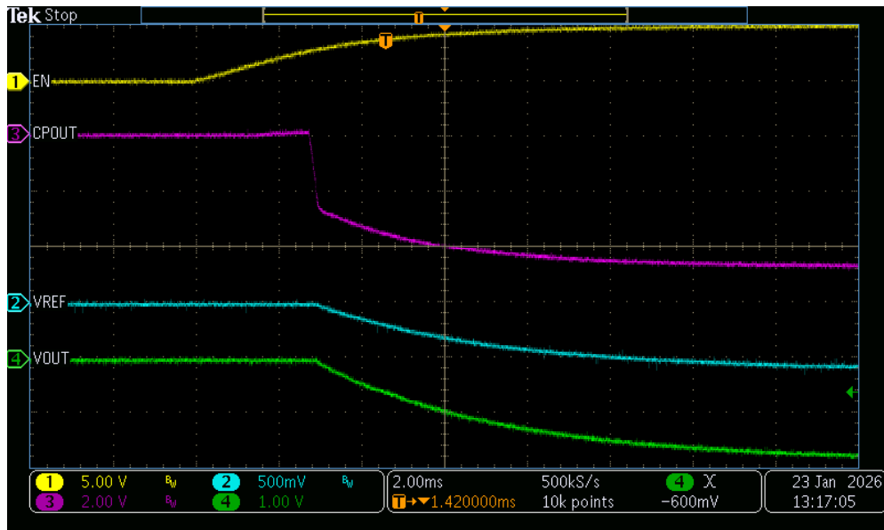
图 3-2. EN 通过电阻分压器连接至上升的 VIN
