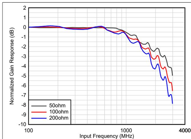
図 7-2. 入力帯域幅プロット (6dB パッド)
