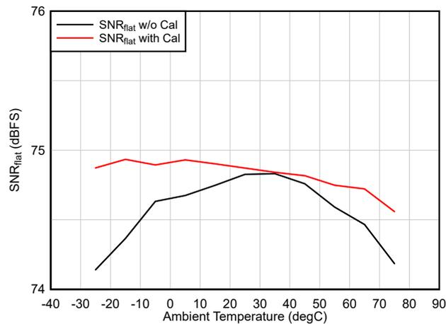
$F_{IN} = 100\text{MHz}$ ,  $A_{IN} = -1\text{dBFS}$ ,  $25^\circ\text{C}$  でキャリブレーション
