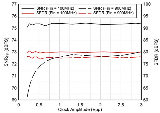
図 5-16. AC 性能とクロック振幅との関係
