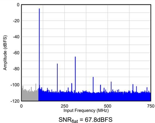
図 5-5.  $F_{IN} = 1400\text{MHz}$  でのシングル トーン FFT
