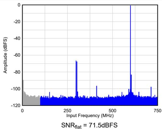
図 5-3.  $F_{IN} = 900\text{MHz}$  でのシングル トーン FFT
