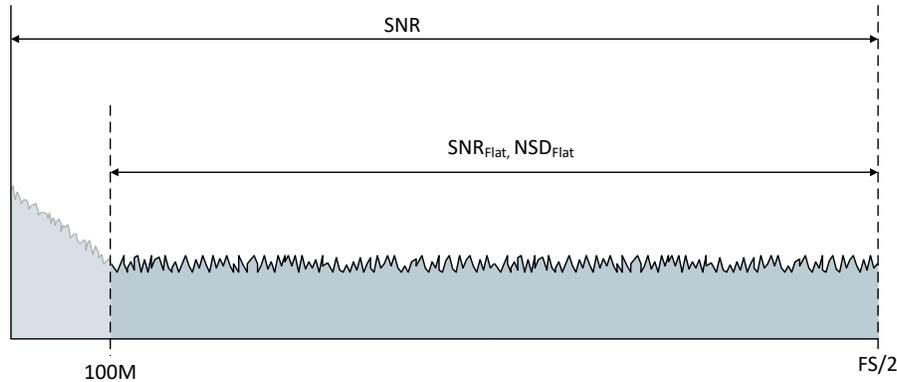
図 6-1. SNR (DC から FS/2) と SNR<sub>flat</sub> (100MHz から FS/2) との関係
