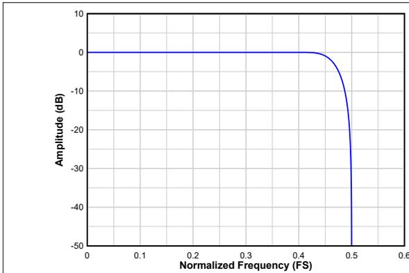
図 7-16. 非整数遅延 FIR のフィルタ応答
