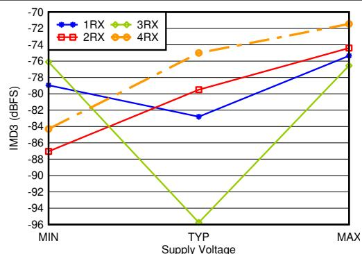
4.9GHz 整合あり、各トーン  $-7\text{dBFS}$ 、20MHz のトーン間隔、すべての電源電圧は推奨動作条件の最小値、代表値、最大値
