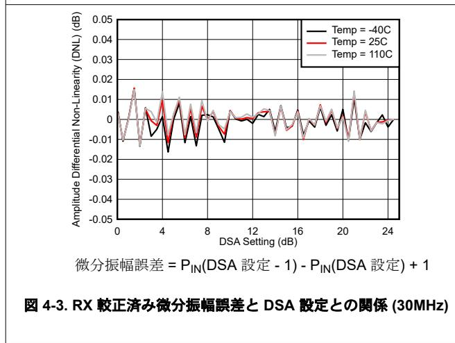
図 4-3. RX 較正済み微分振幅誤差と DSA 設定との関係 (30MHz)
