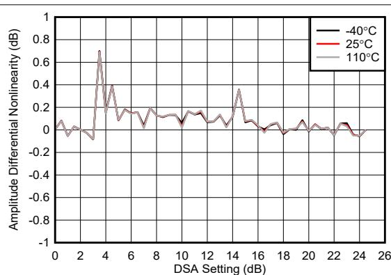
図 4-203. 6.851GHz での RX 未較正微分振幅誤差
