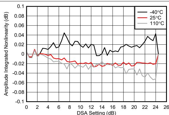
図 4-206. 6.851GHz での RX 較正済み積分振幅誤差
