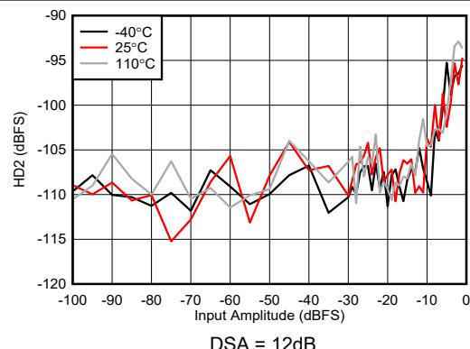
図 4-223. RX HD2 と入力振幅との関係 (6.851GHz)
