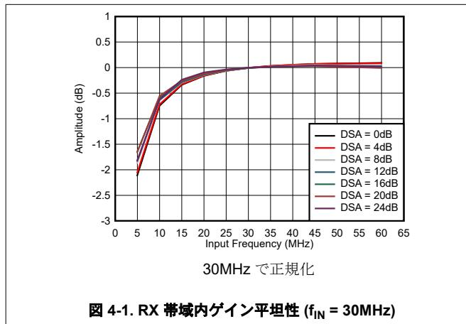
図 4-1. RX 帯域内ゲイン平坦性 ( $f_{\text{IN}} = 30\text{MHz}$ )
