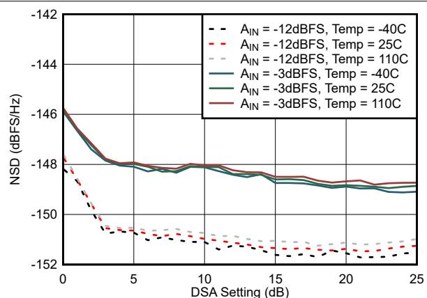
$f_{\text{ADC}} = 1500\text{MSPS}$ 、 $f_{\text{NCO}} = 32.13\text{MHz}$ 、24x によってデシメーション
