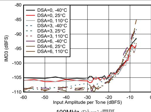
図 4-217. RX IMD3 と入力振幅との関係 (6.851GHz)
