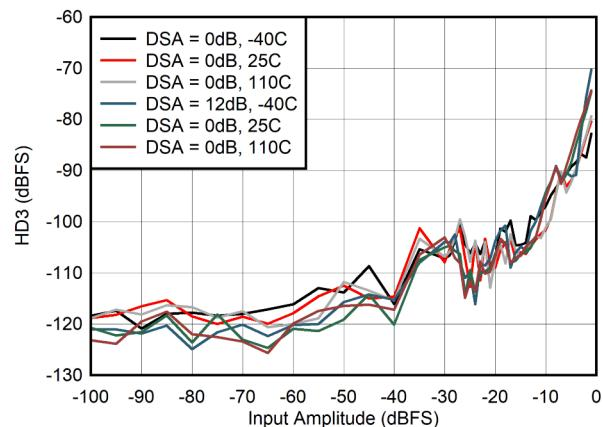
図 4-48. 400MHz での HD3 と入力振幅との関係
