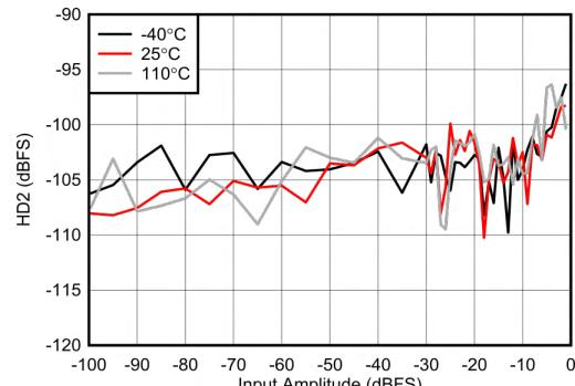
図 4-221. RX HD2 と入力振幅との関係 (6.851GHz)
