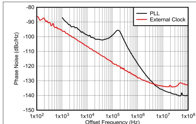
TX 出力で測定、 $20^*\log 10$  で  $12\text{GHz}$  に正規化 ( $12\text{GHz}/F_{\text{OUT}}$ )
