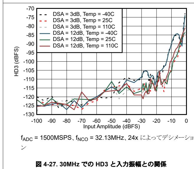
図 4-27. 30MHz での HD3 と入力振幅との関係
