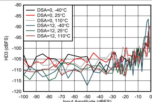
図 4-225. RX HD3 と入力振幅との関係 (6.851GHz)
