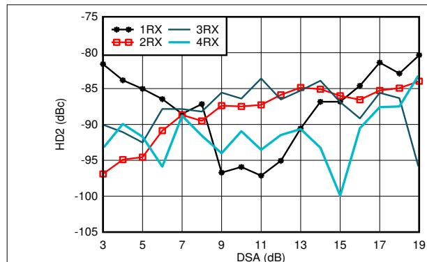
1.8GHz 整合あり、 $f_{\text{in}} = 1900\text{MHz}$ 、HD2 調整後に測定、DDC バイパス モード (特性評価用 テキサス・インスツルメンツ専用モード)
