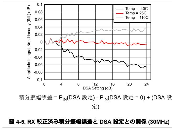
図 4-5. RX 較正済み積分振幅誤差と DSA 設定との関係 (30MHz)
