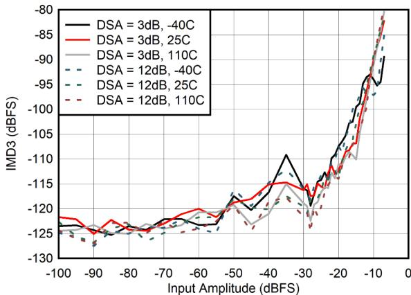
図 4-45. 400MHz での IMD3 と入力振幅との関係
