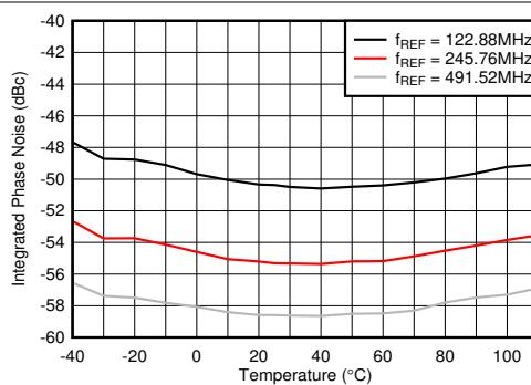
PLL イネーブル、 $f_{VCO} = 9830.4\text{MHz}$ 、1kHz ~ 100MHz、片側積分帯域幅、2TXOUT で測定
