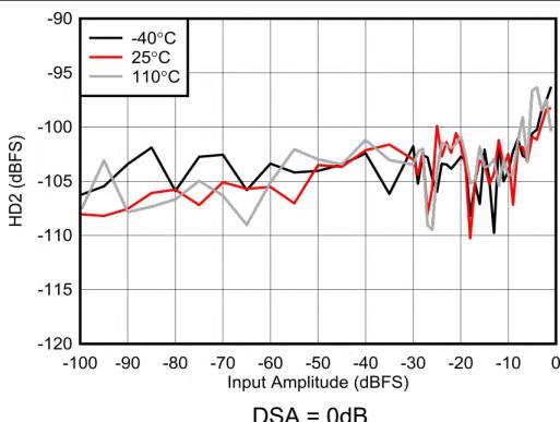
図 4-222. RX HD2 と入力振幅との関係 (6.851GHz)
