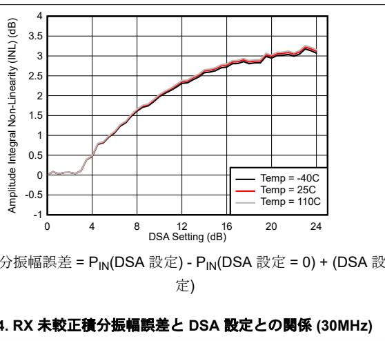
図 4-4. RX 未較正積分振幅誤差と DSA 設定との関係 (30MHz)
