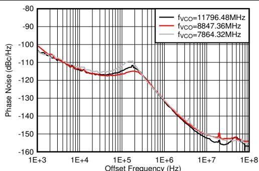
PLL イネーブル、 $f_{\text{REF}} = 491.52\text{MSPS}$ 、 $2\text{TXOUT}$  で測定
