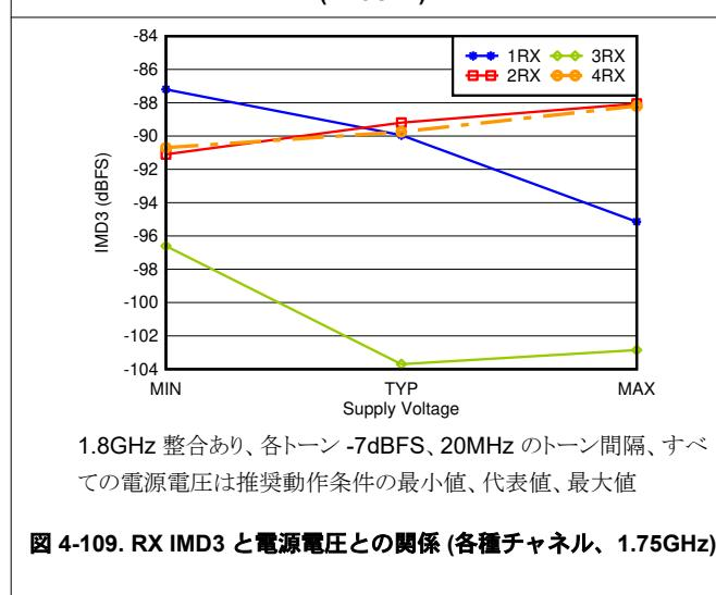
1.8GHz 整合あり、各トーン -7dBFS、20MHz のトーン間隔、すべての電源電圧は推奨動作条件の最小値、代表値、最大値
