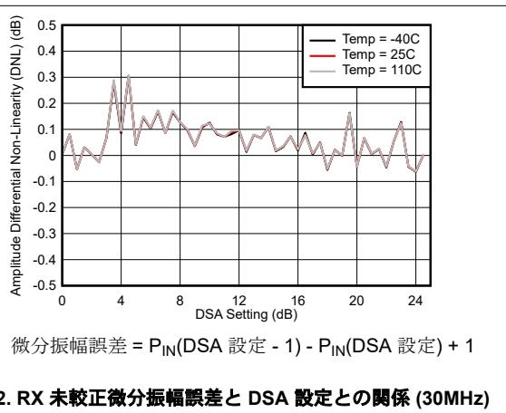
図 4-2. RX 未較正微分振幅誤差と DSA 設定との関係 (30MHz)
