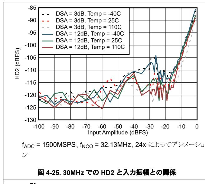
図 4-25. 30MHz での HD2 と入力振幅との関係
