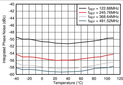
PLL イネーブル、 $f_{VCO} = 11796.48\text{MHz}$ 、1kHz ~ 100MHz、片側
