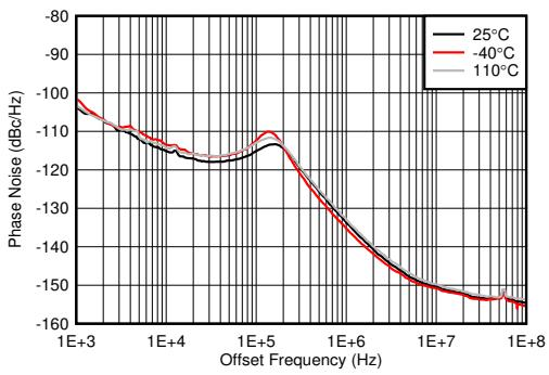
PLL イネーブル、 $f_{VCO} = 9830.4\text{MHz}$ 、 $f_{REF} = 491.52\text{MSPS}$ 、2TXOUT で測定
