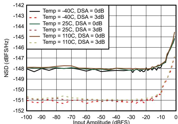
$f_{\text{ADC}} = 1500\text{MSPS}$ 、 $f_{\text{NCO}} = 32.13\text{MHz}$ 、24x でデシメーション
