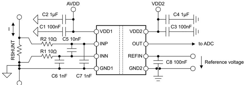
図 8-6. AMC0x00R のデカップリング
