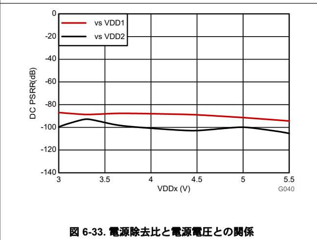
図 6-33. 電源除去比と電源電圧との関係
