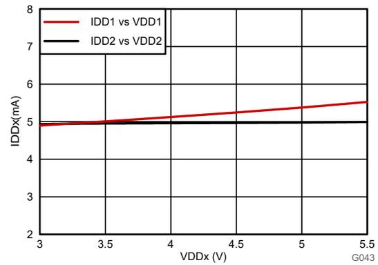
図 6-37. 電源電流と電源電圧との関係
