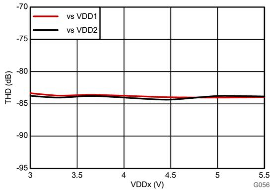
図 6-26. 合計高調波歪みと電源電圧との関係
