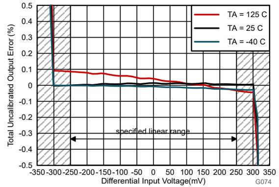
キャリブレーションされていない出力誤差の合計は次のように定義されます:  $((V_{OUT\_Measured} - V_{OUT\_Expected}) / V_{REFIN}) \times 100$ , ここで  $V_{OUT\_Expected} = V_{IN} / V_{Clipping} \times V_{REFIN} / 2 + V_{REFIN} / 2$ ,  $V_{REFIN} = 3.3\text{V}$  および  $V_{Clipping} = 0.32\text{V}$
