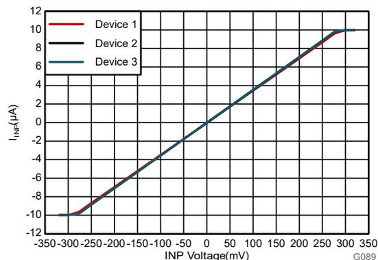
図 6-19. 入力電流と入力電圧との関係
