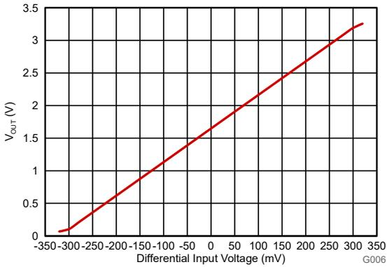
図 6-6. 出力電圧と入力電圧との関係
