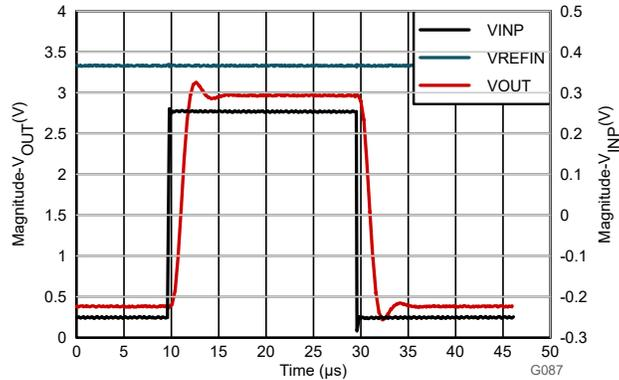
図 8-4. AMC0x00R の出力ステップ応答
