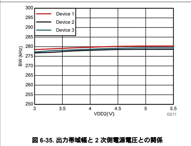
図 6-35. 出力帯域幅と 2 次側電源電圧との関係
