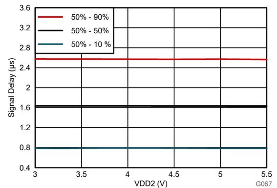
図 6-41.  $V_{IN}$  から  $V_{OUT}$  への信号遅延とローサイド電源電圧との関係
