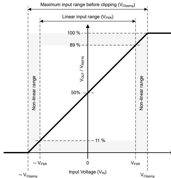
図 7-3. AMC0x00R の入力から出力への伝達曲線
