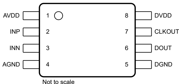
図 5-1. DWV および D パッケージ、8 ピン SOIC (上面図)
