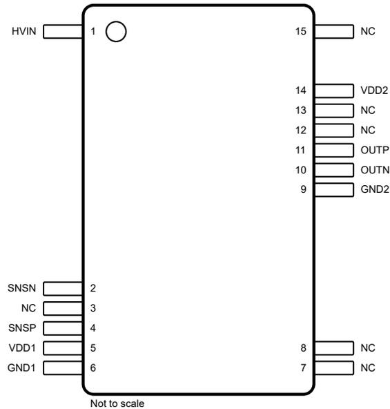
図 5-1. DFX パッケージ、15 ピン SOIC (上面図)
