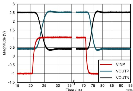
図 8-4. AMC0380D-Q1 のステップ応答
