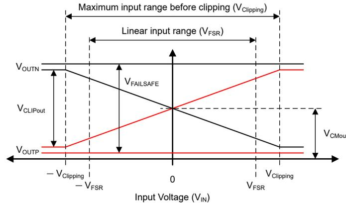
図 7-2. AMC0380D-Q1 の入力から出力への伝達曲線
