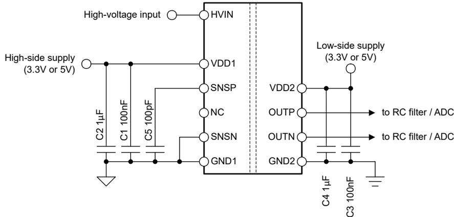
図 8-5. AMC0380D-Q1 のデカップリング
