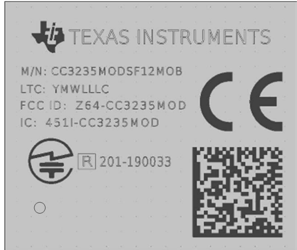
☒ 8-4. CC3235MODSF Module Marking
