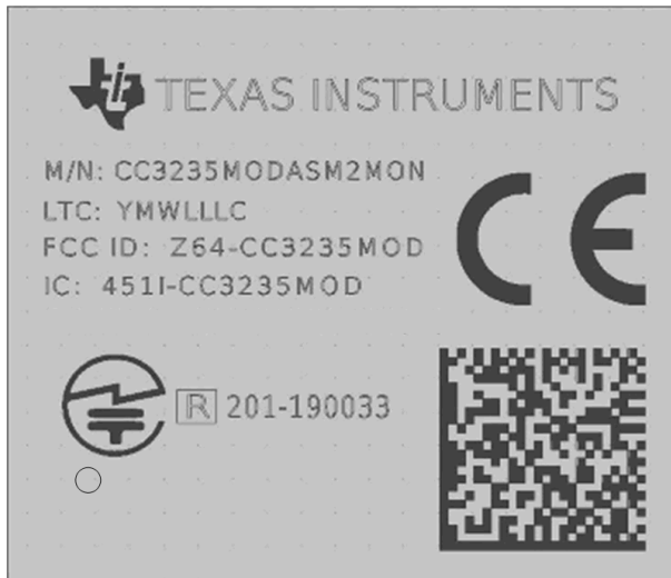
☒ 8-5. CC3235MODAS Module Marking
