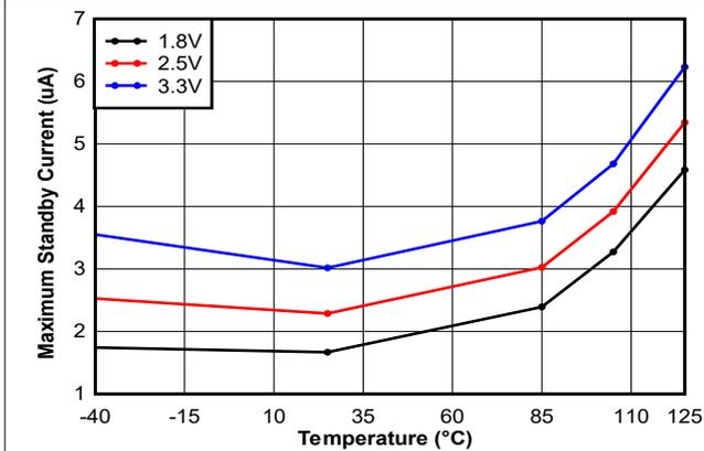
図 6-7. スタンバイ電流の最大値と温度および電源電圧との関係
