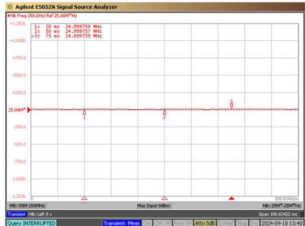
図 8-9. 1500g の間の機械的衝撃 (25MHz および 25°C、Y 軸)
