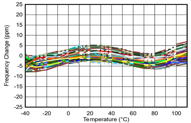
図 6-14. 周波数変化と温度との関係 (25MHz および 2.5V 電源、デバイス 100 台)
