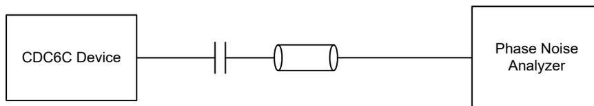
図 7-2. CDC6Cx-Q1 の出力位相ノイズテスト構成
