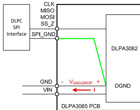
**Figure 7-6. SPI Connections**
