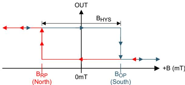
図 6-2. 出力状態 (FA、AD、AG、BC バージョン)
