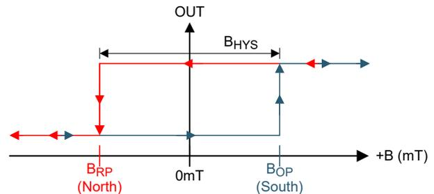
図 6-3. 反転出力状態 (ND、FD バージョン)
