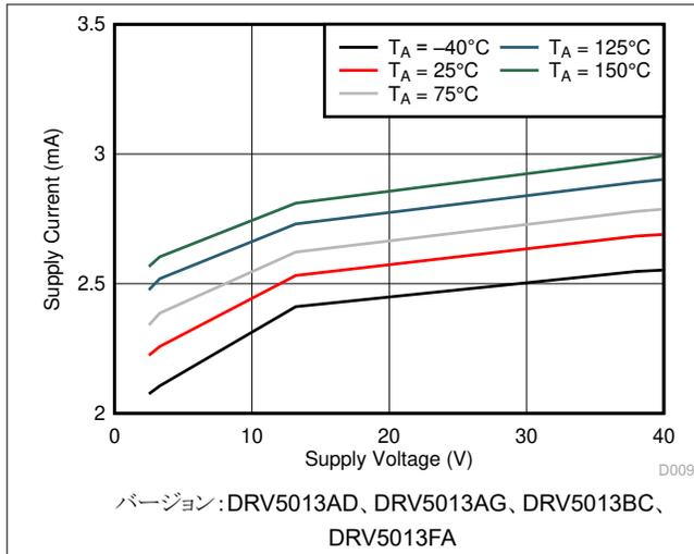
図 5-1.  $I_{CC}$  と  $V_{CC}$  との関係
