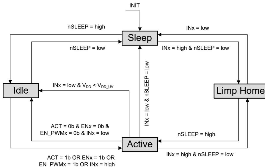
図 7-5. 動作モードの状態図
