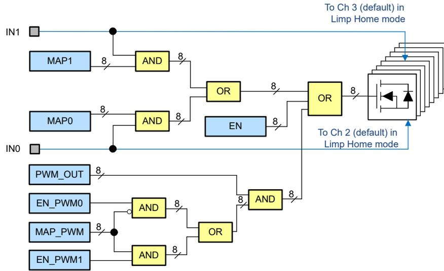
図 7-10. PWM ジェネレータのマッピング
