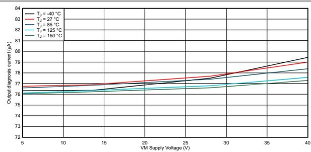
図 6-9. 出力診断電流、VDD = 5.5V
