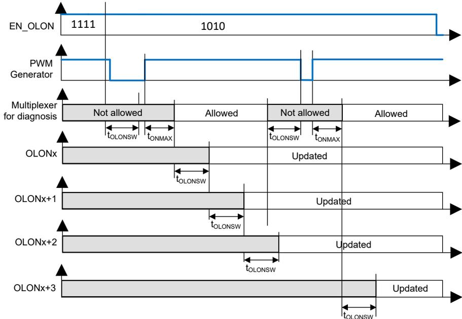
図 7-19. オン時開放負荷診断のタイミング (診断ループ - 内部 PWM ジェネレータ制御チャンネル)
