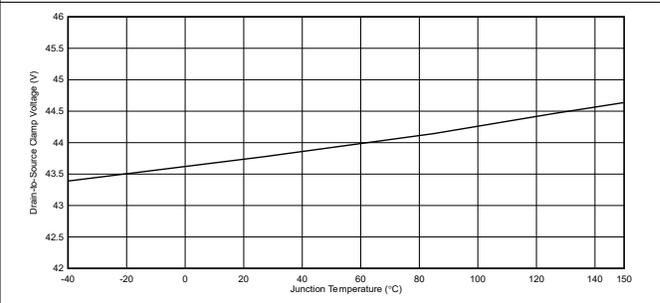
図 6-5. ドレイン-ソース間クランプ電圧
