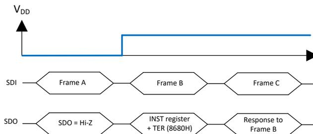
**図 7-25. V<sub>DD</sub> でのパワーオン リセットから復帰した後の応答**
