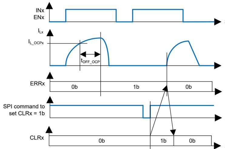
図 7-13. 過電流時にラッチオフする
