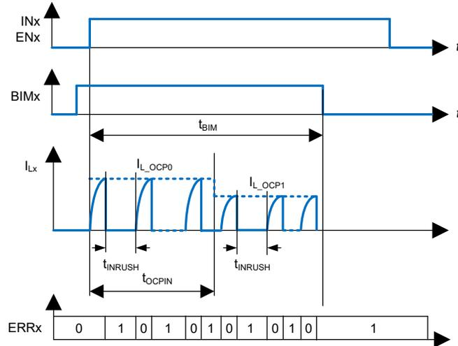
図 7-9. 電球突入モード (BIM) 動作
