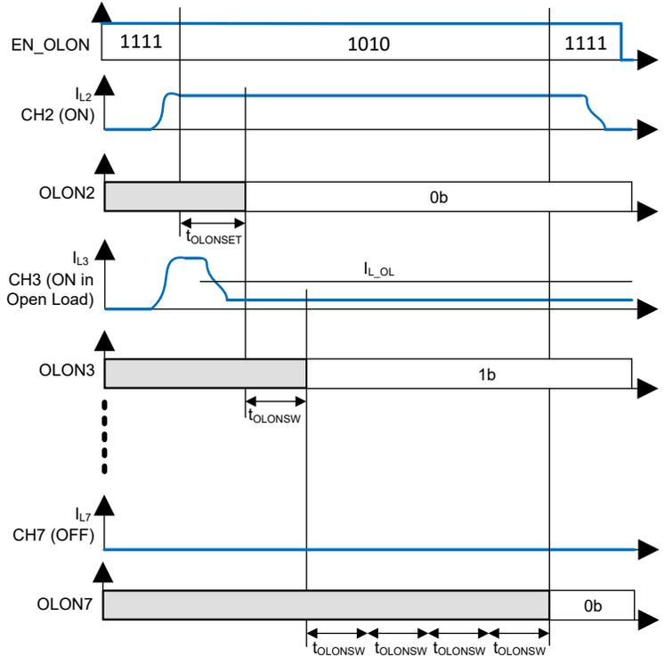
図 7-18. オン時開放負荷診断のタイミング (診断ループ - マイコン制御チャンネル)
