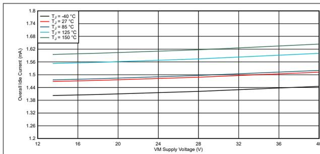
図 6-2. アイドルモード消費電流、VDD = 5.5V
