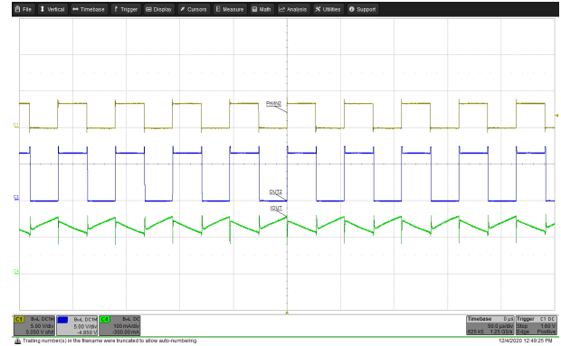
A. チャンネル 1 = IN2 チャンネル 2 = V_{OUT2} チャンネル 4 = モーター一電流
