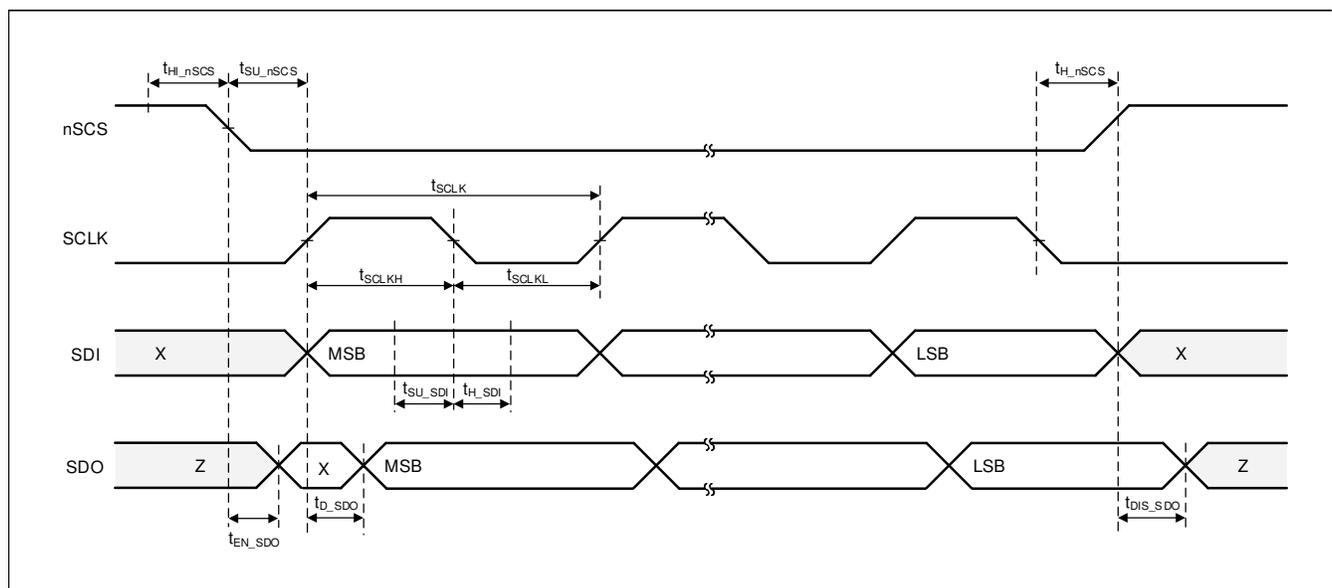
図 5-1. SPI スレーブ モード タイミング図
