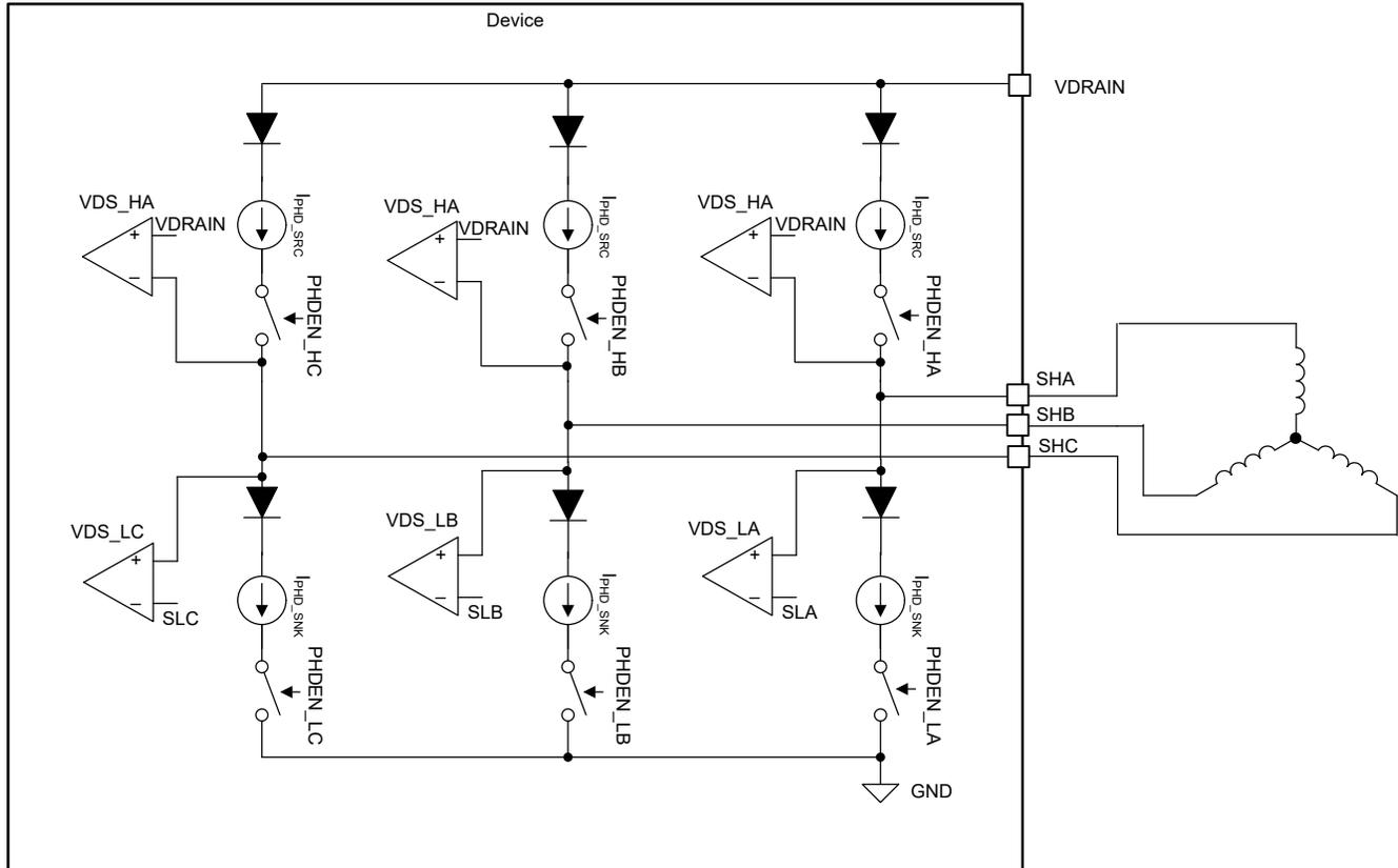
図 6-23. 位相診断 (開発中製品のみ)
