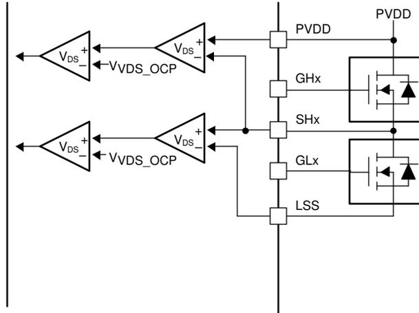
図 6-19. DRV8334-Q1 V<sub>DS</sub> モニタ
