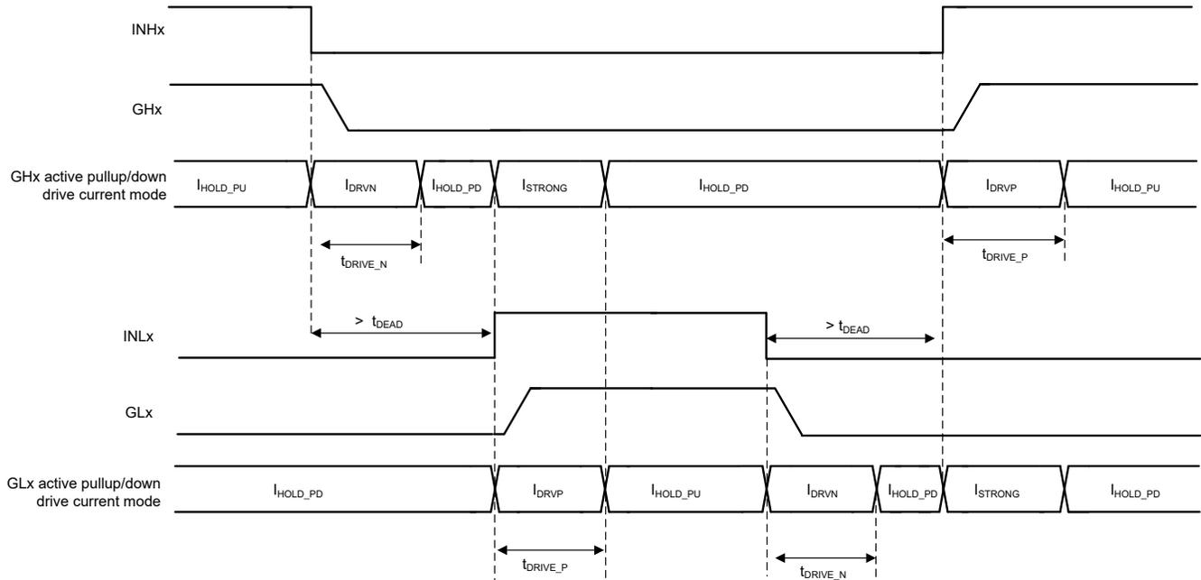
図 6-6. TDRIVE ゲート駆動タイミング制御 (DEADT\_MODE=0b)
