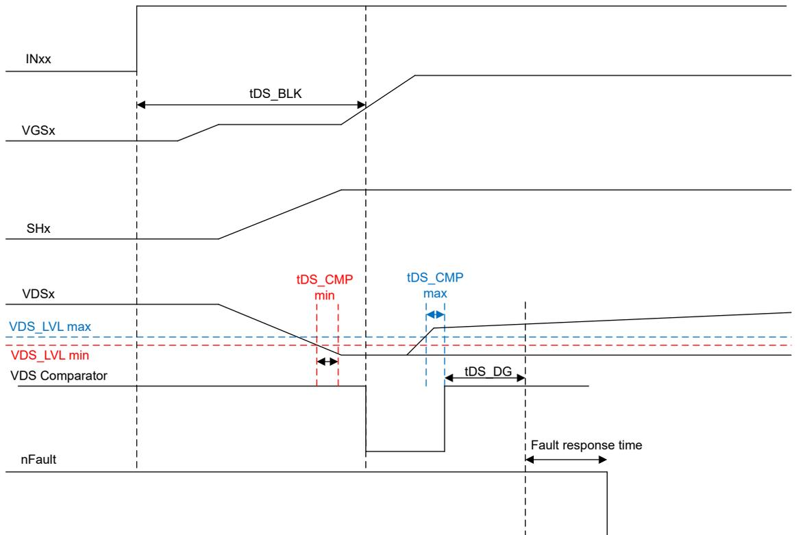
図 6-20. DRV8334-Q1 V<sub>DS</sub> モニタのタイミング
