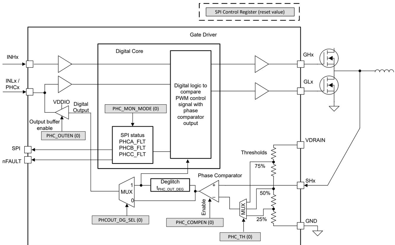
図 6-21. 位相コンパレータの機能図
