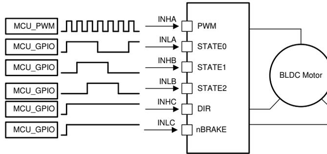
図 6-2. 1x PWM — 単純なコントローラ
