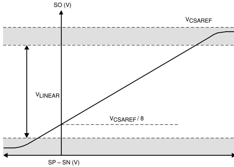
図 6-10. 単方向電流検出の出力
