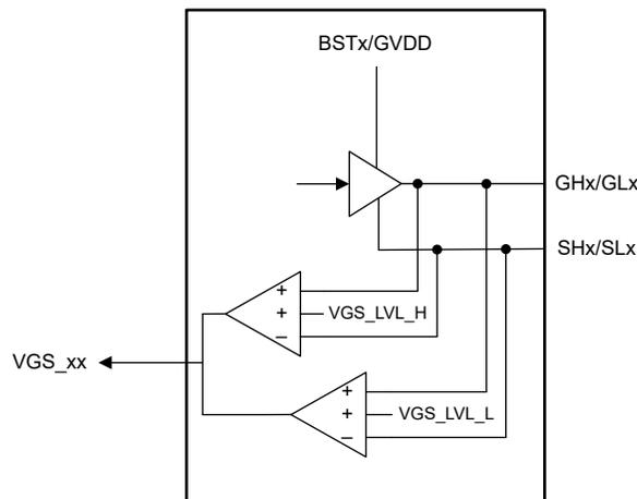
図 6-16. DRV8334-Q1 V<sub>GS</sub> モニタ
