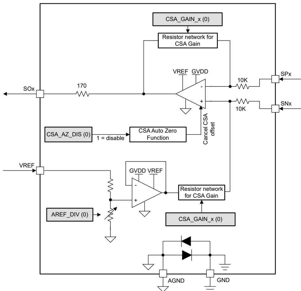
図 6-9. 電流センスアンプの図
