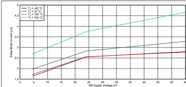
図 5-2. スリープモード電源電流
