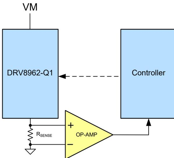
図 6-2. 外付け抵抗による電流検出
