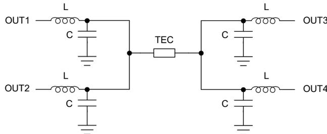
図 7-9. 1 つの TEC を大電流で駆動
