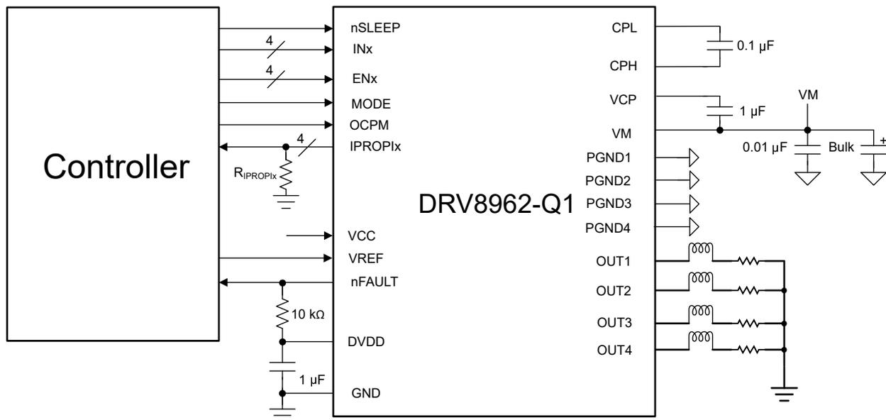
図 7-1. DRV8962-Q1 によるソレノイドの駆動
