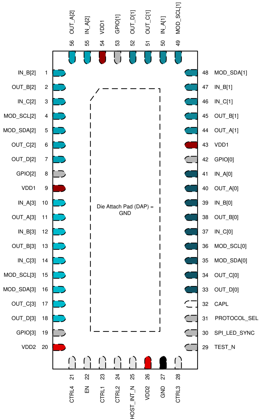
图 6-1. RHU Package 56-Pin QFN Top View
