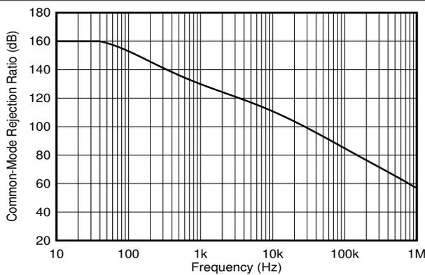
**6-9. Common-Mode Rejection Ratio vs. Frequency**
