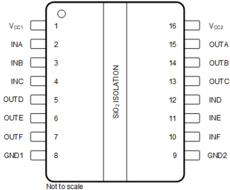
図 4-1. DW Package, 16-Pin ワイド SOIC (Top View)
