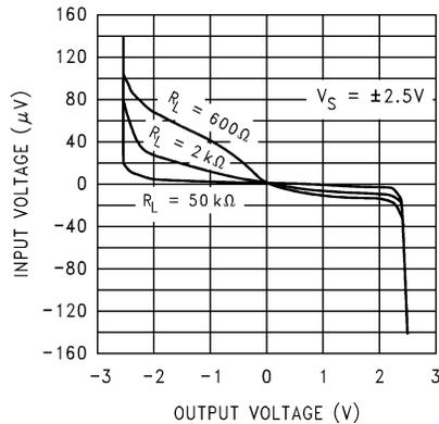
図 5-17. 入力電圧と出力電圧との関係
