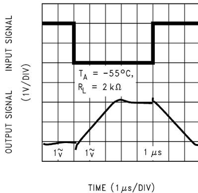
図 5-33. 反転型の大信号パルス応答
