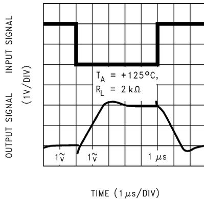
図 5-31. 反転型の大信号パルス応答
