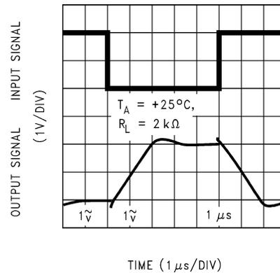
図 5-32. 反転型の大信号パルス応答
