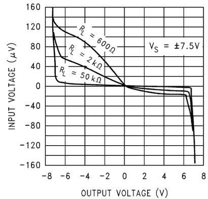
図 5-16. 入力電圧と出力電圧との関係
