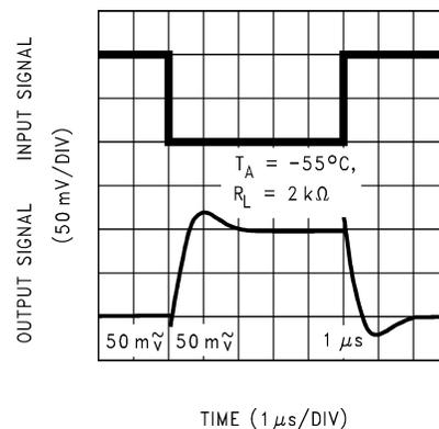
図 5-36. 反転型の小信号パルス応答
