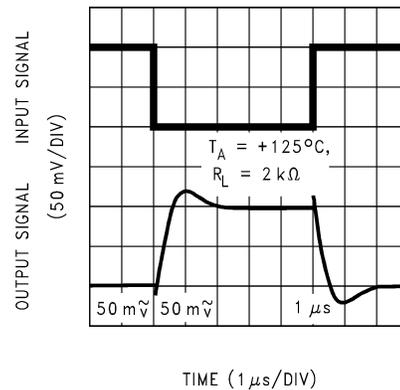
図 5-34. 反転型の小信号パルス応答
