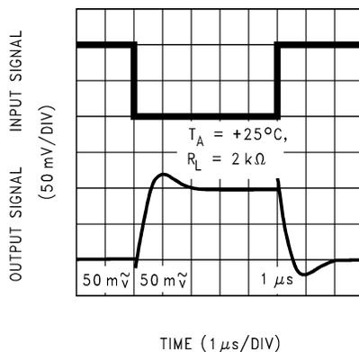
図 5-35. 反転型の小信号パルス応答
