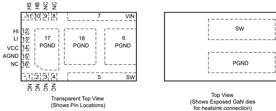
图 4-1. VBN Package, 18-Pin VQFN (Top View)
