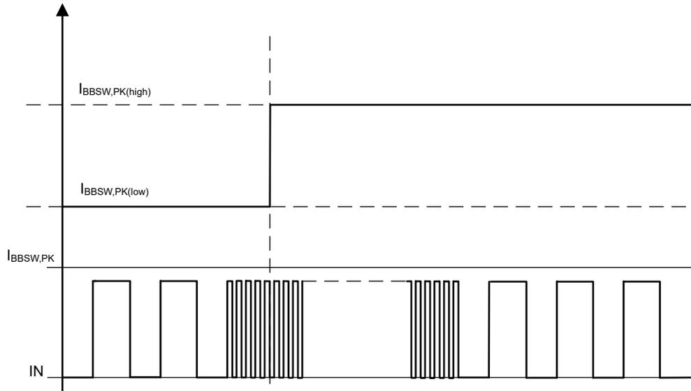
図 7-3. 昇降圧コンバータのピーク電流
