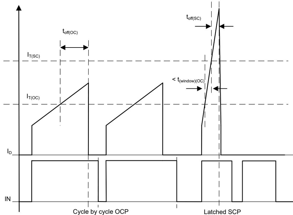
図 7-5. 過電流検出と短絡保護との関係
