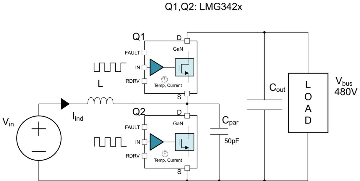
図 6-3. SOA 曲線に使用する回路
