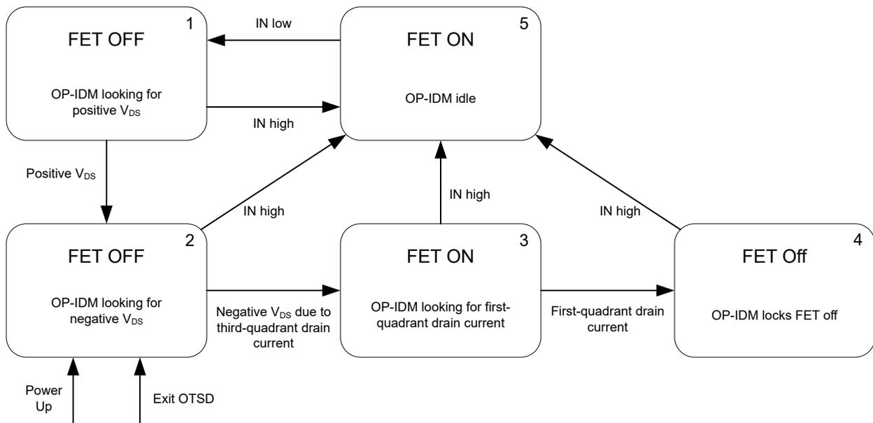
図 7-6. 動作中の最適ダイオード・モード (OP-IDM) ステート・マシン
