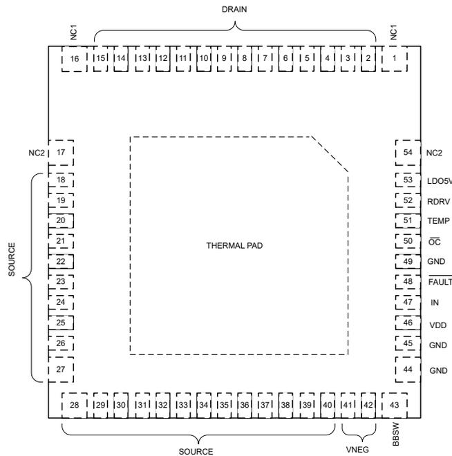
図 4-1. RQZ パッケージ、54 ピン VQFN ( 上面図 )
