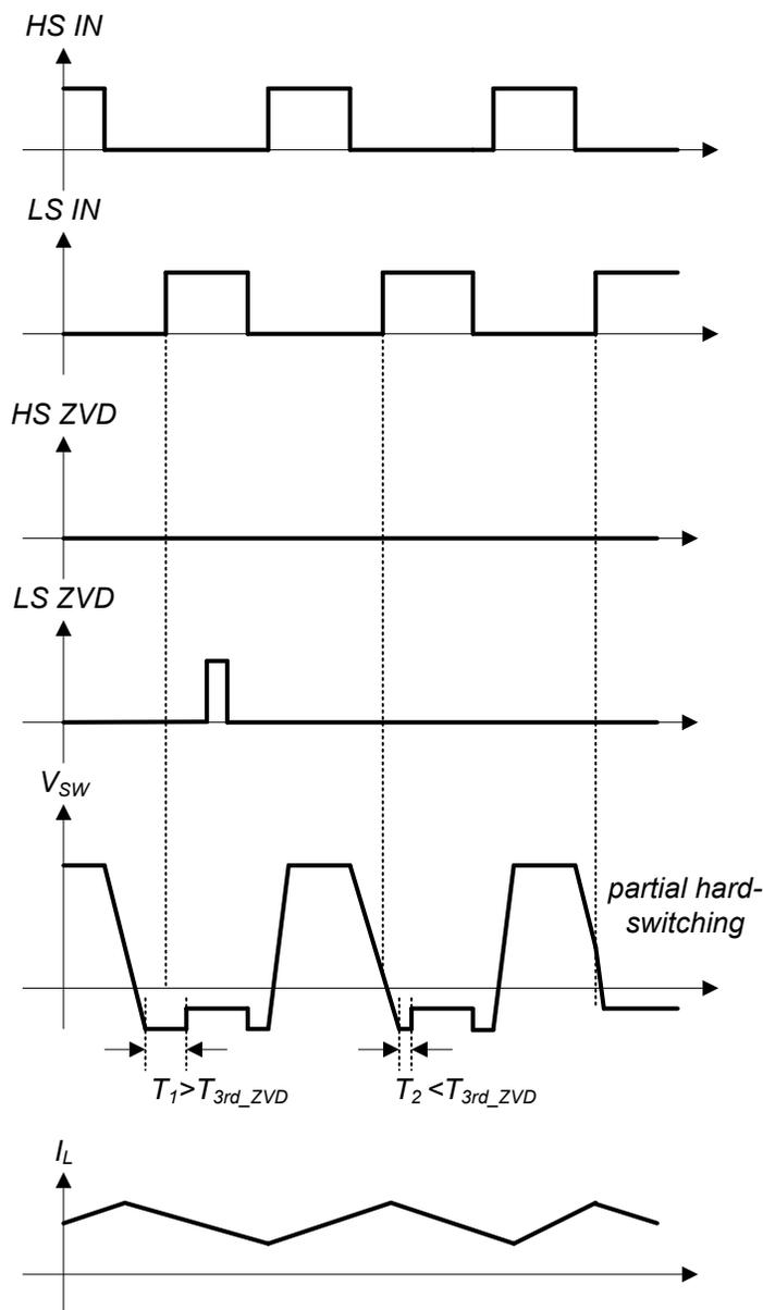
図 7-6. CCM 降圧コンバータでの ZVD 機能
