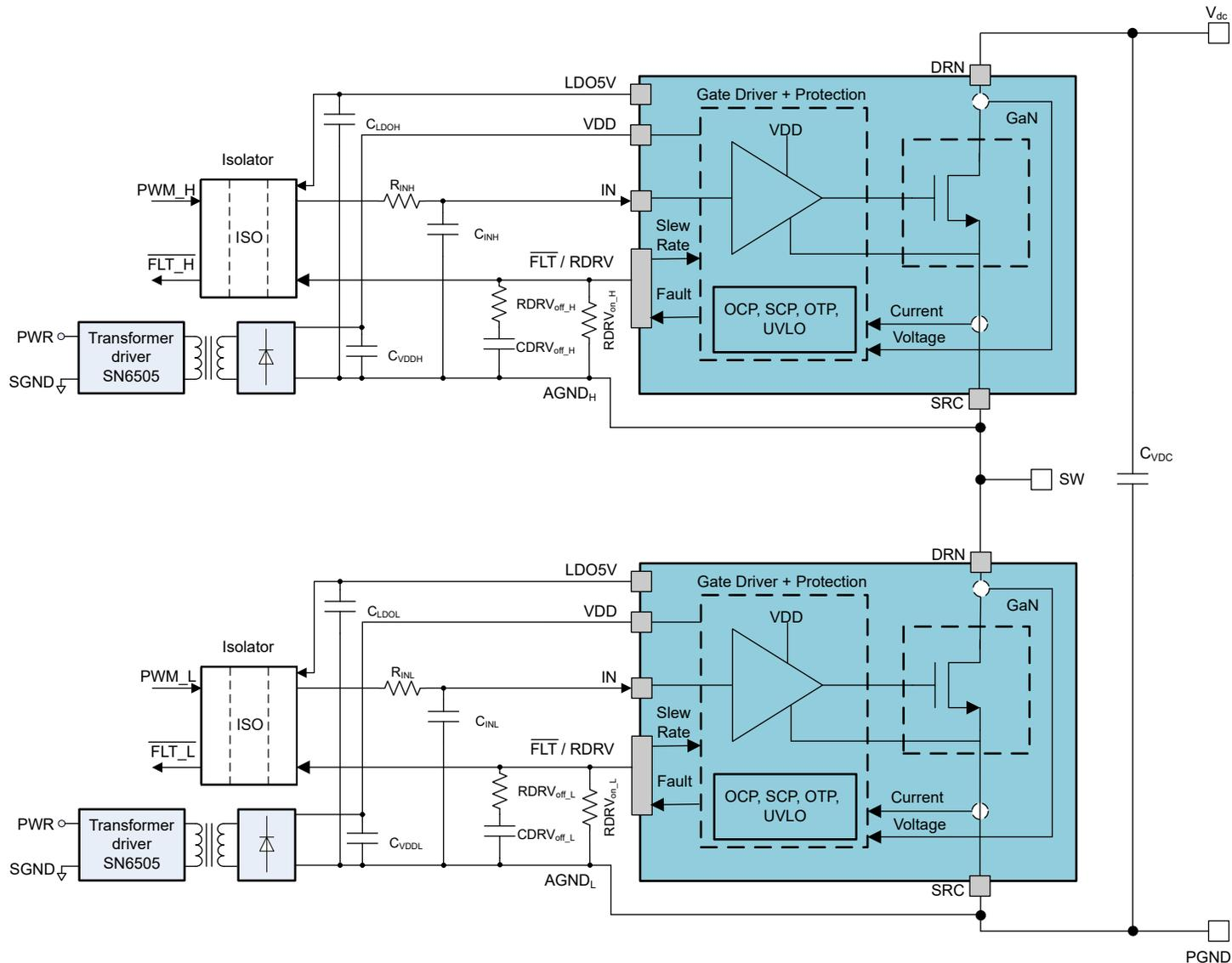
図 8-2. LMG3651R025 絶縁型電源を使用した標準的なハーフブリッジアプリケーション
