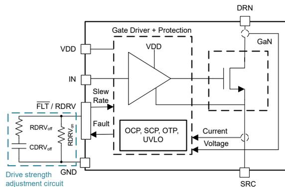
図 7-1. ドライブ強度調整回路
