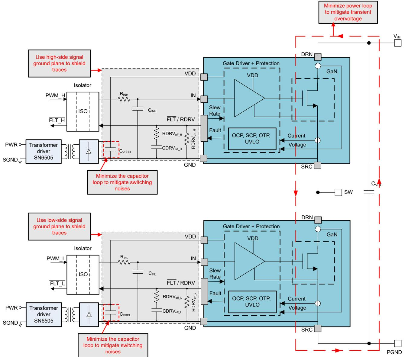
図 8-9. LMG3650R025 レイアウトに関する考慮事項付きの代表的な回路図
