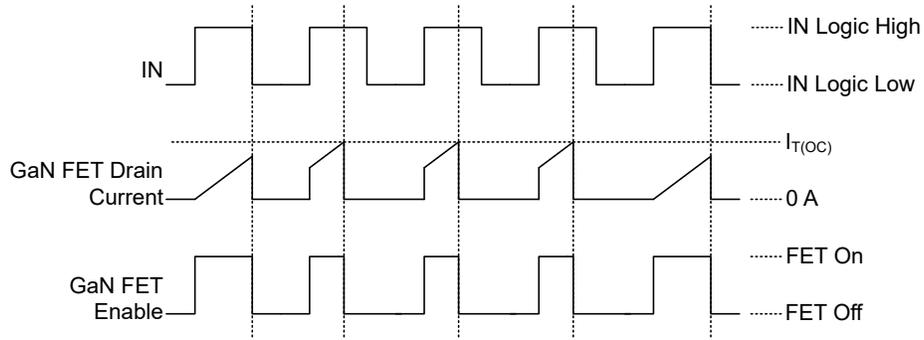
図 7-3. サイクル単位の過電流保護動作
