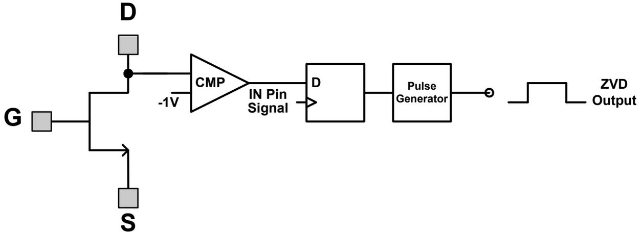
図 7-5. ゼロ電圧検出回路のブロック図
