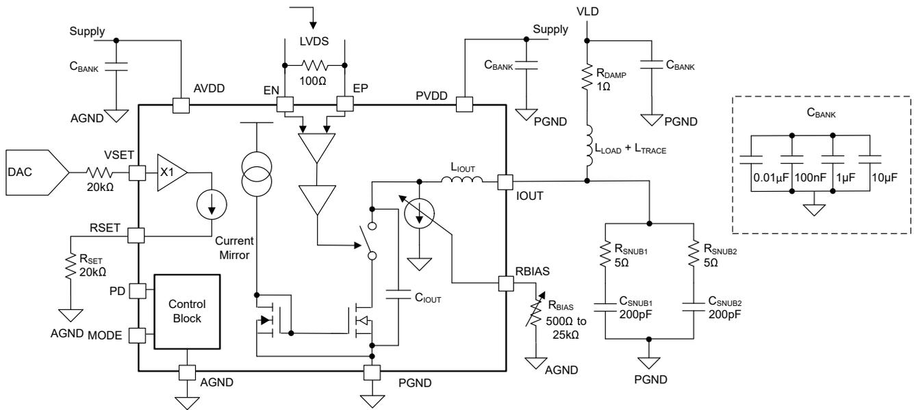
図 5-31. 電気的パラメータ測定回路
