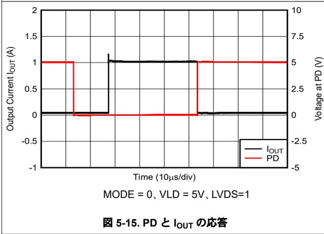
図 5-15. PD と  $I_{OUT}$  の応答
