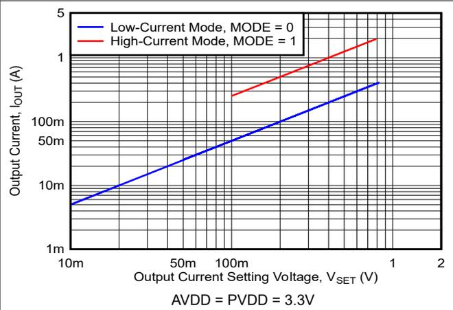
図 5-2.  $V_{SET}$  を  $I_{OUT}$  に変換する伝達特性
