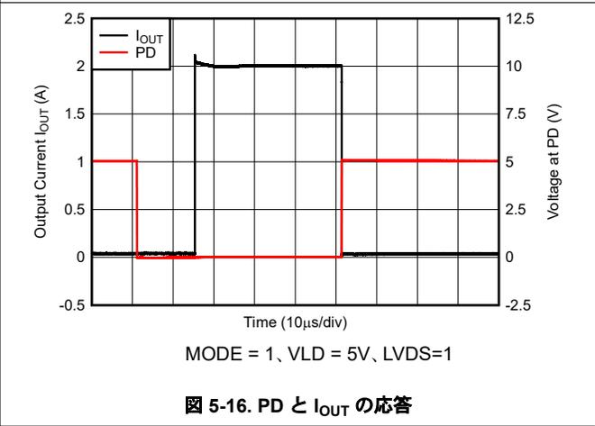
図 5-16. PD と  $I_{OUT}$  の応答
