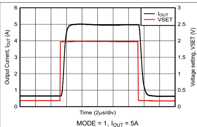
図 5-20. VSET から  $I_{OUT}$  へのステップ応答
