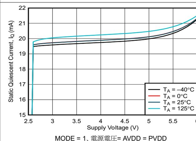
図 5-24. スタティック静止電流と電源電圧との関係
