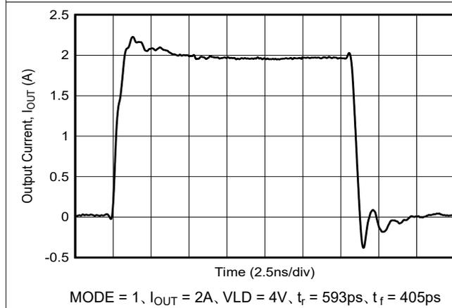
図 5-9.  $I_{\text{OUT}}$  フェーズ応答
