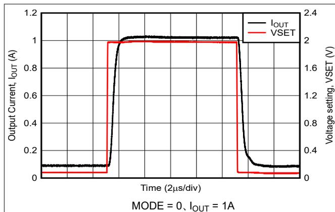
図 5-19. VSET から  $I_{OUT}$  へのステップ応答
