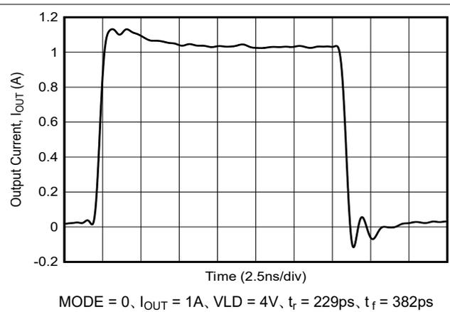
図 5-8.  $I_{\text{OUT}}$  フェーズ応答
