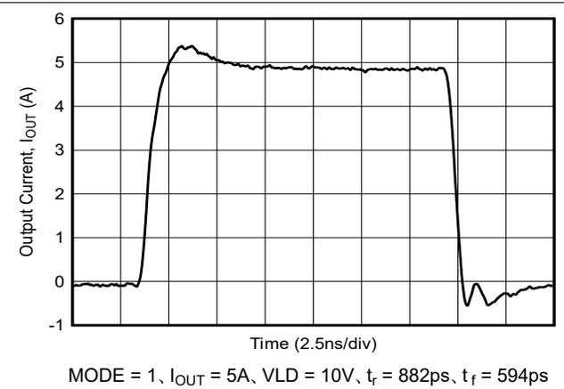
図 5-10.  $I_{\text{OUT}}$  フェーズ応答
