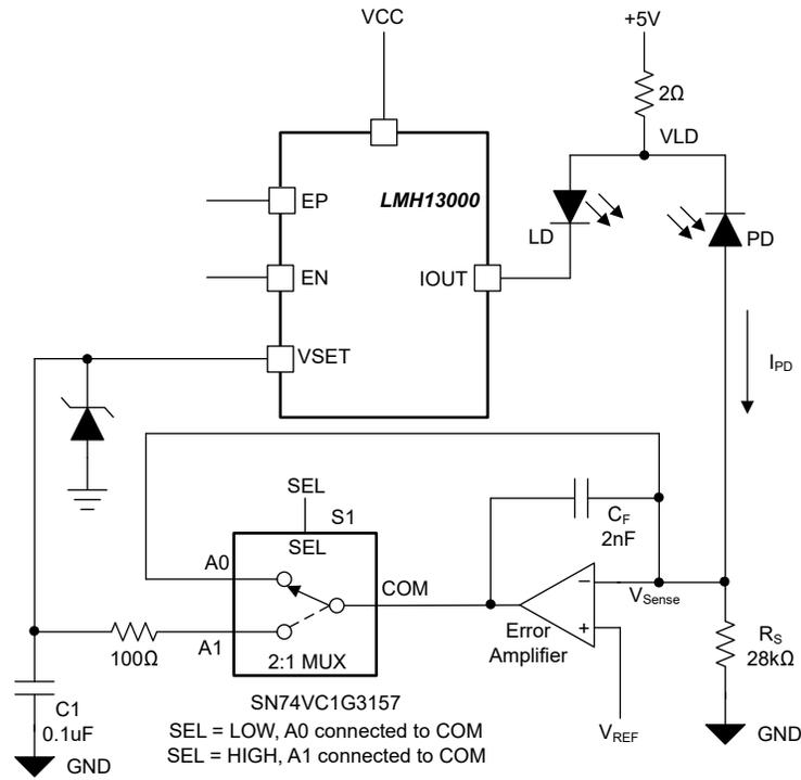
図 7-5. LMH13000 をパルス動作で使用した自動電力制御ループ
