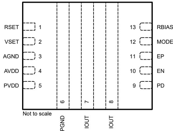
図 4-1. RQE パッケージ 13 ピン WQFN-HR (上面図)
