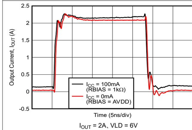
図 5-11.  $I_{\text{CC}}$  あり/なしでの  $I_{\text{OUT}}$  パルス応答
