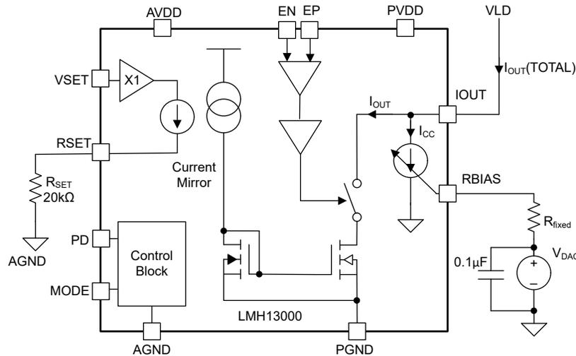
図 6-1. 動的  $I_{CC}$  制御回路
