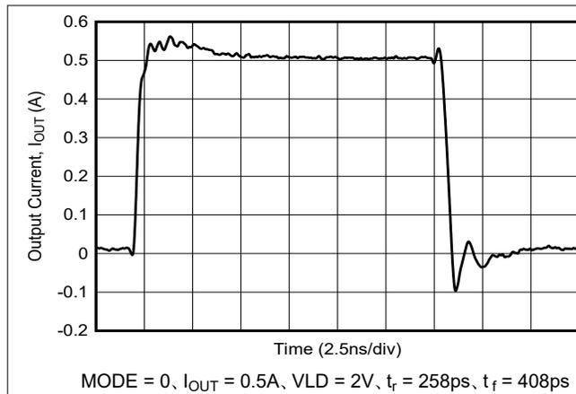
図 5-7.  $I_{\text{OUT}}$  フェーズ応答
