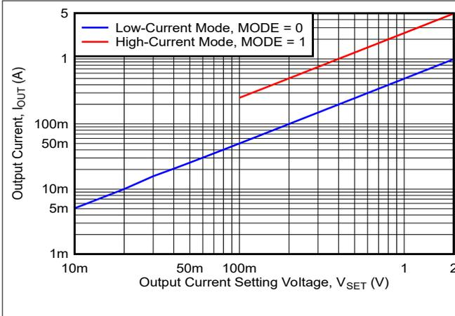
図 5-1.  $V_{SET}$  を  $I_{OUT}$  に変換する伝達特性
