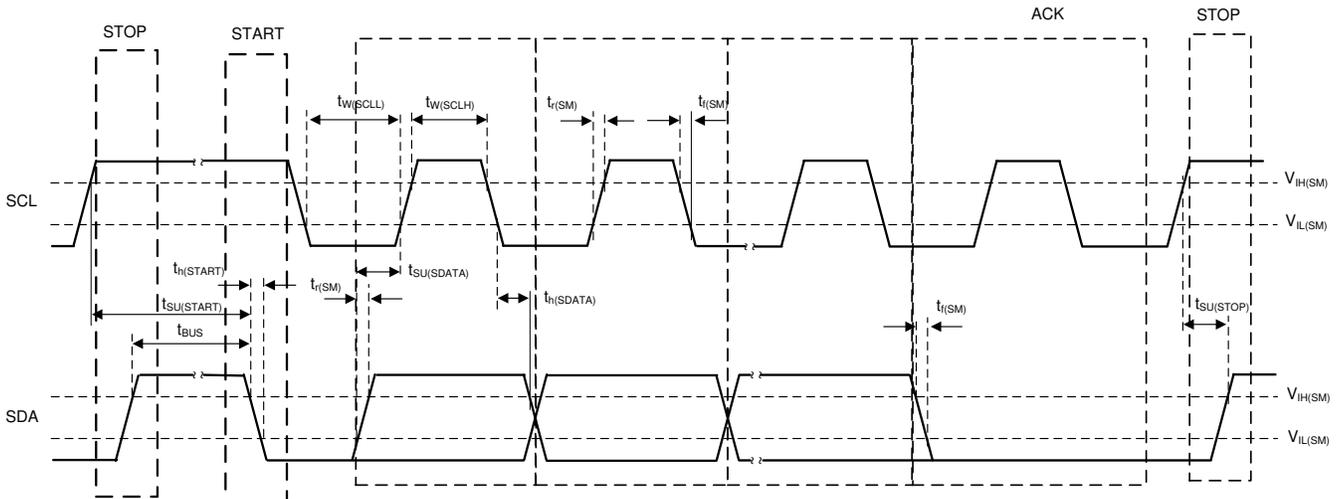
図 6-4. I<sup>2</sup>C Timing Diagram
