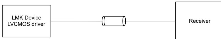
図 8-26. LVCMOS Output Termination
