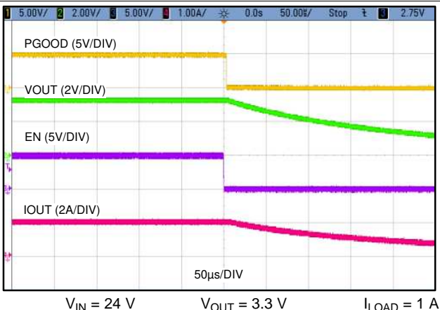
图 27. Enable Shutdown Waveform
