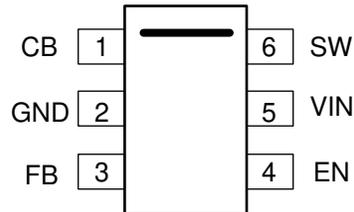
图 6-1. 6-Pin SOT-23-6 DBV Package (Top View)
