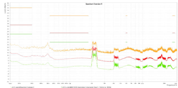
図 8-27. 伝導 EMI と CISPR25 制限値との関係 (紫: ピーク信号、緑: 平均信号)、LMR60440QEV
