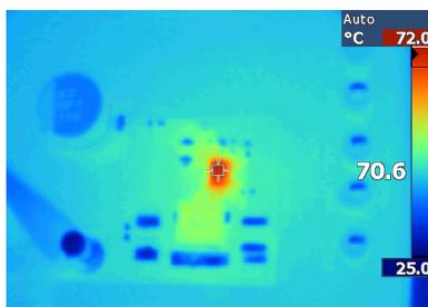
デバイスの種類 = 3A 5V 固定出力 モード = 自動
