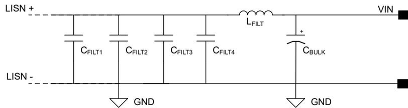
図 8-35. 標準入力 EMI フィルタ回路図
