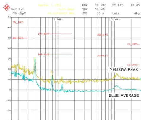
LMS3655-Q1 の伝導 EMI :  $V_{OUT} = 5V$ 、 $I_{OUT} = 5A$
