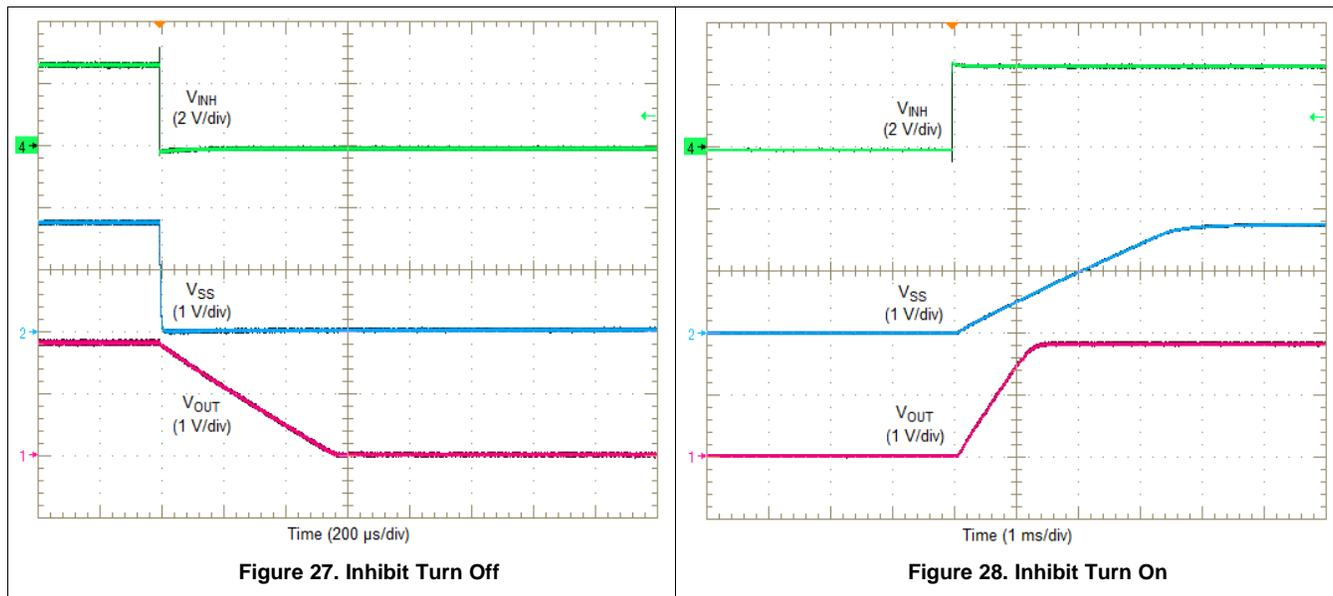
Figure 27. Inhibit Turn Off
