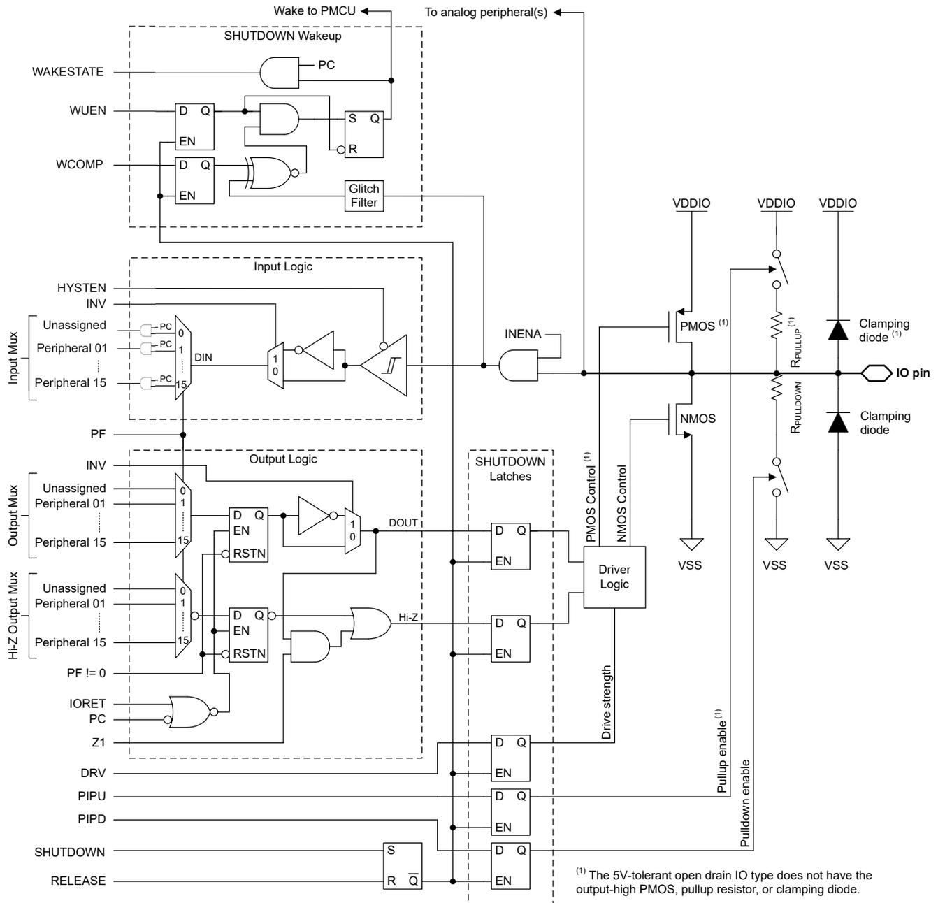
図 8-2. 入力 / 出力の回路図 (上位セット)
