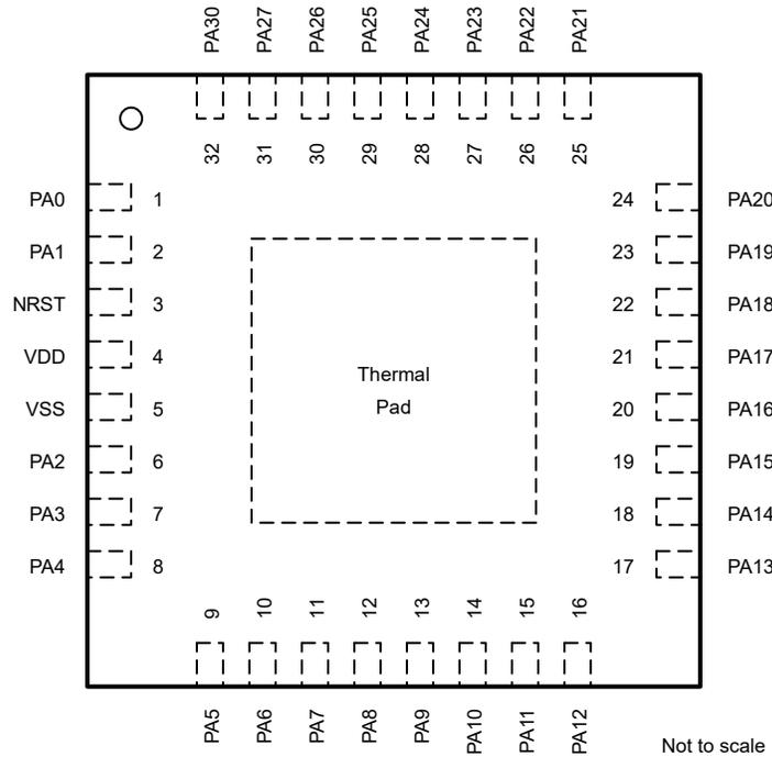
図 6-4. 32 ピンの RHB (VQFN) パッケージ
