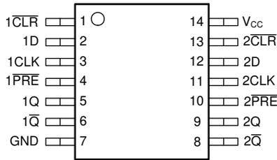
図 4-1. PW パッケージ、14 ピン TSSOP (上面図)
