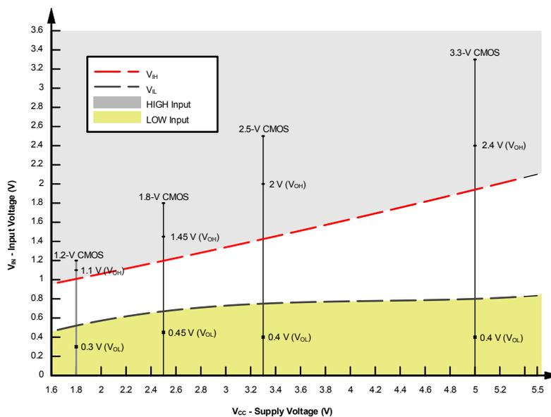
図 7-2. SCxT の入力電圧レベル
