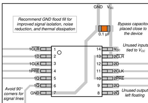
図 8-4. レイアウト例 : SN54SC2T74-SEP
