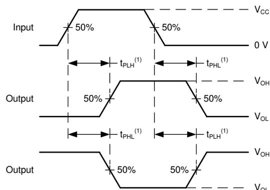
(1)  $t_{\text{PLH}}$  と  $t_{\text{PHL}}$  の大きい方が  $t_{\text{pd}}$  に相当します。
