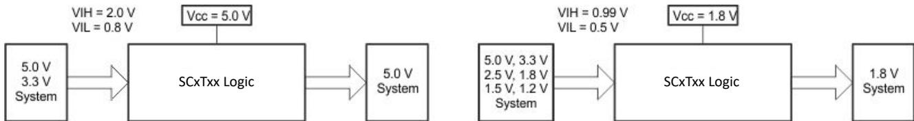
図 7-3. SCxT の昇圧および降圧変換の例
