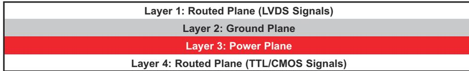
図 10-3. 4 層 PCB 基板
