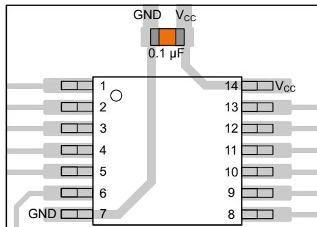
図 8-4. TSSOP や類似のパッケージに対応するバイパス コンデンサの配置例
