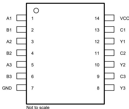
図 4-1. SN74AC3G98-Q1 PW パッケージ、14 ピン
