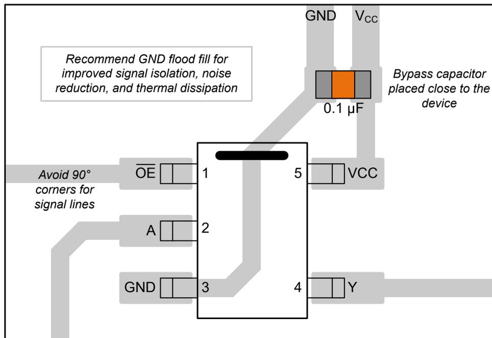
図 11-1. SN74AHC1G125-Q1 のレイアウト例
