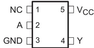
図 4-3. DRL Package 5-Pin SOT Top View
