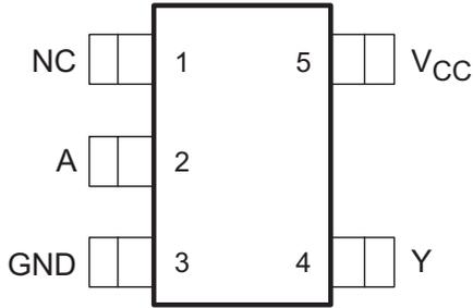
図 4-1. DBV Package 5-Pin SOT-23 Top View
