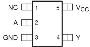
図 4-2. DCK Package 5-Pin SC70 Top View
