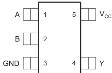
図 4-1. DBV Package 5-Pin SOT-23 Top View
