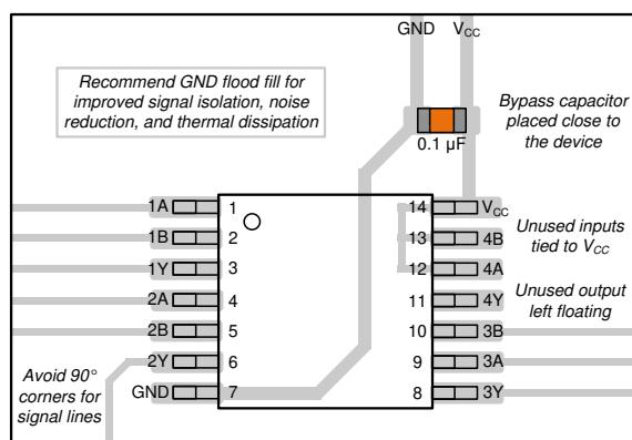
図 8-3. SN74AHCT00Q-Q1 のレイアウト例
