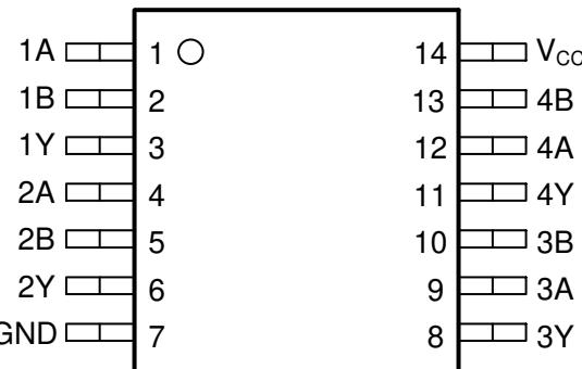
図 4-2. D または PW パッケージ、14 ピン SOIC または TSSOP (上面図)
