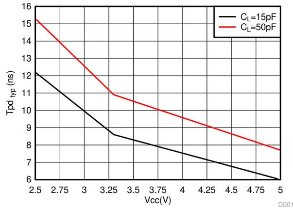
图 6-2. T<sub>PD</sub> Typical (25°C) vs V<sub>CC</sub>
