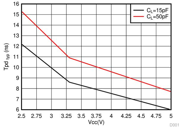
图 6-2.  $T_{PD}$  Typical ( $25^\circ\text{C}$ ) vs  $V_{CC}$
