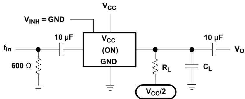
図 6-9. Sine-Wave Distortion
