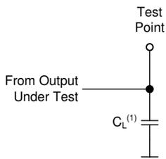
(1) C<sub>L</sub> にはプローブとテスト装置の容量が含まれます。
