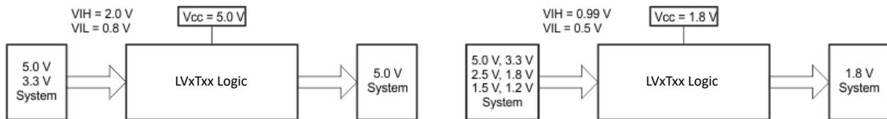
図 7-3. LVxT の昇圧および降圧変換の例
