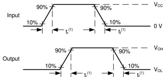
(1) t<sub>r</sub> と t<sub>f</sub> の大きい方が t<sub>t</sub> に相当します。
