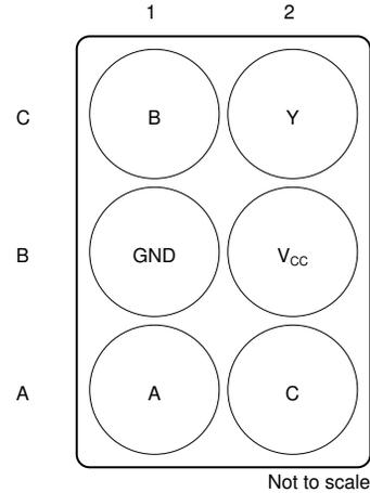
図 4-2. YZP パッケージ 6 ピン DSBGA 底面図
