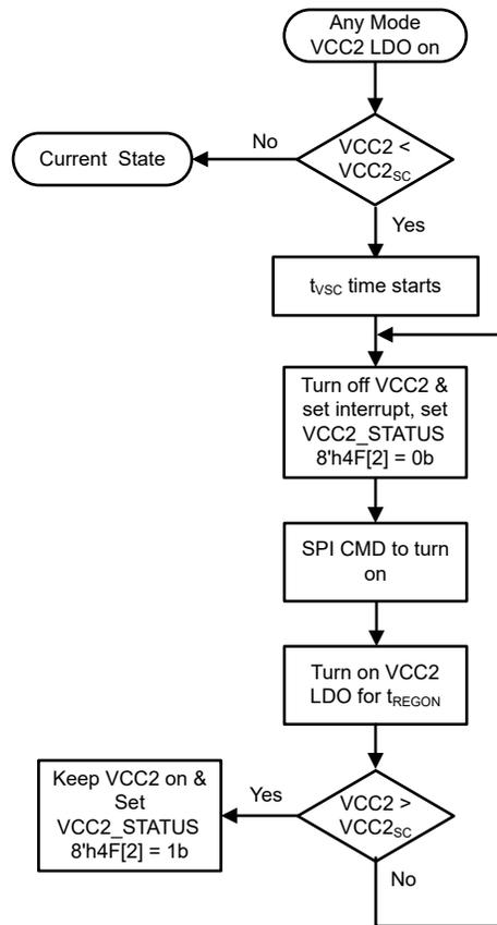
図 8-37. VCC2<sub>SC</sub> の状態図
