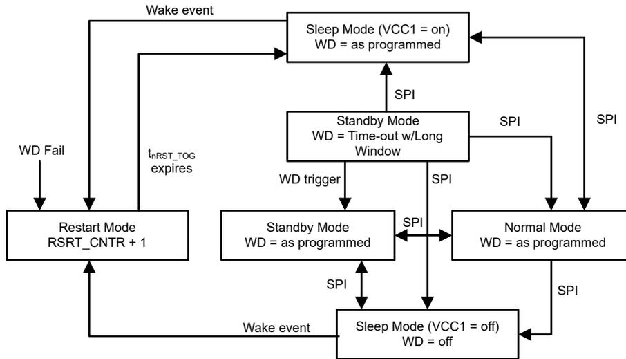
図 8-40. スリープモードのウォッチドッグ
