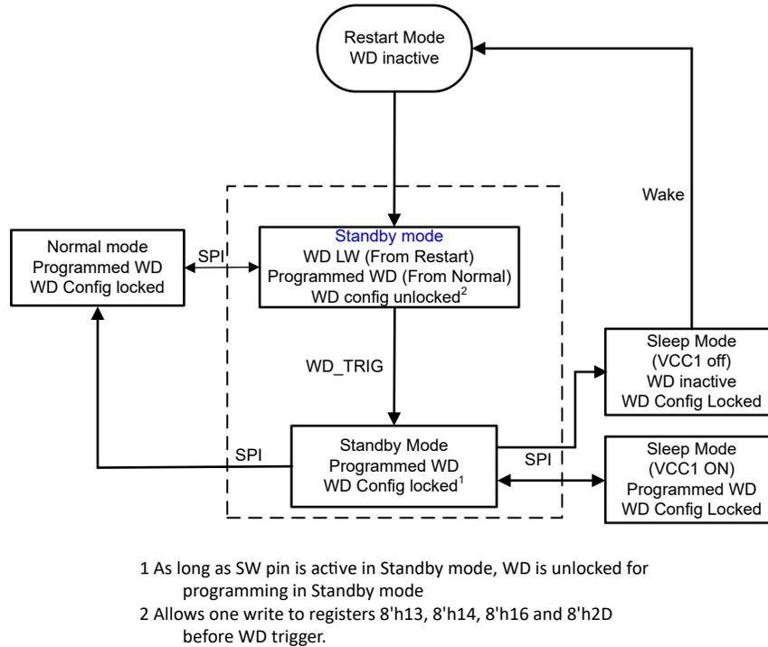
図 8-41. ウォッチドッグ構成レジスタのロックおよびロック解除フローチャート
