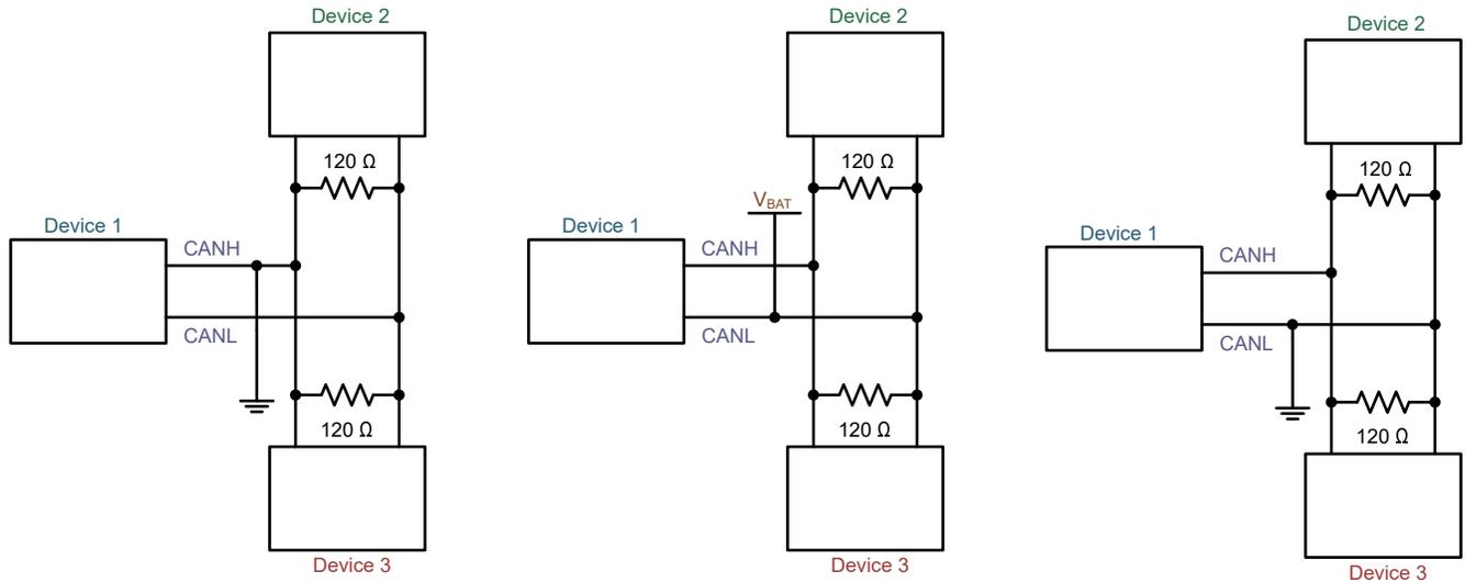
図 8-51. 短絡故障 7、8、9 の例
