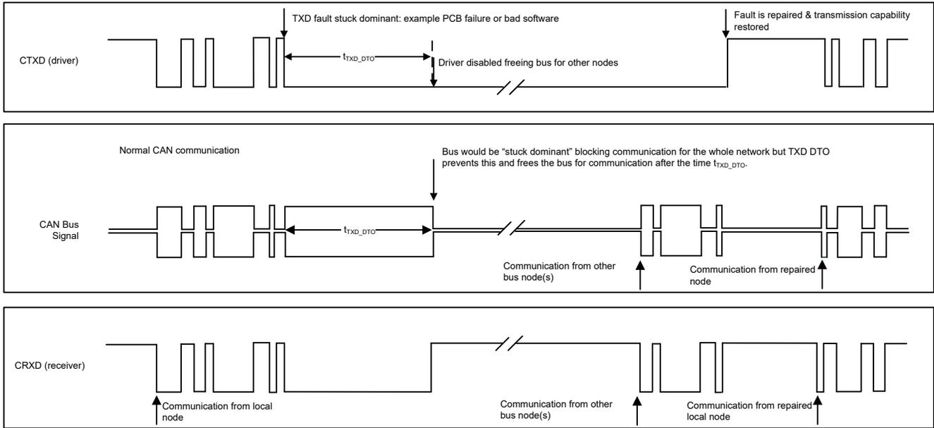
図 8-17. TXD DTO のタイミング図の例
