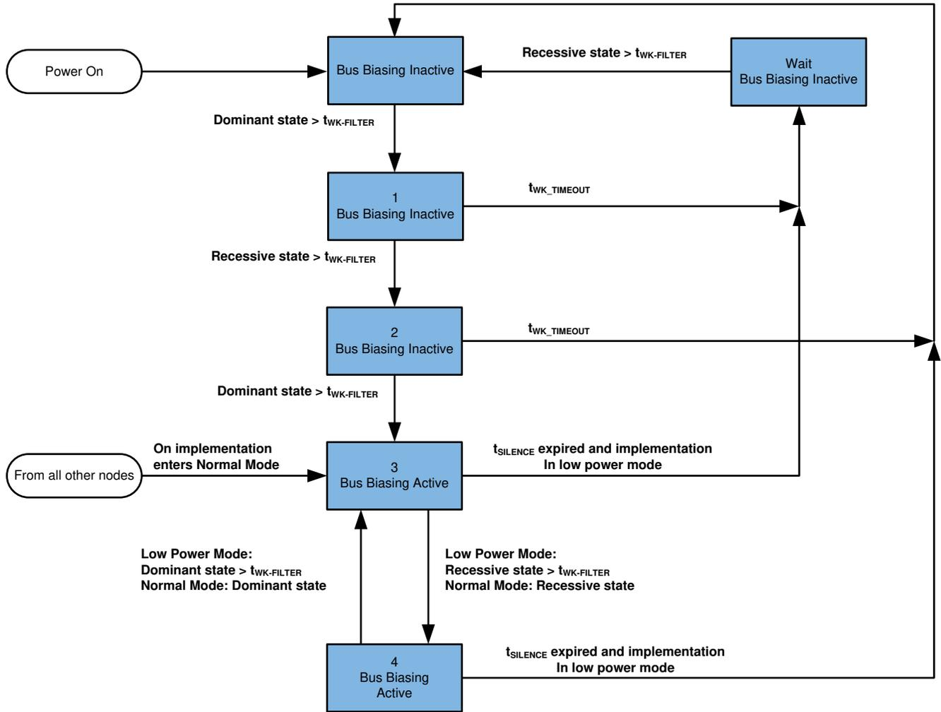
図 10-1. 自動バスバイアス印加の状態図
