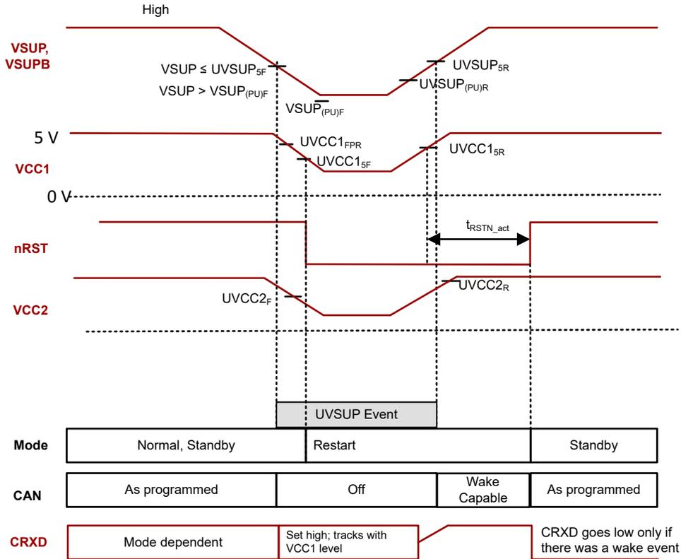
図 10-3. VCC1 = 5V の場合に VSUP<sub>(PU)F</sub> を上回るブラウンアウト
