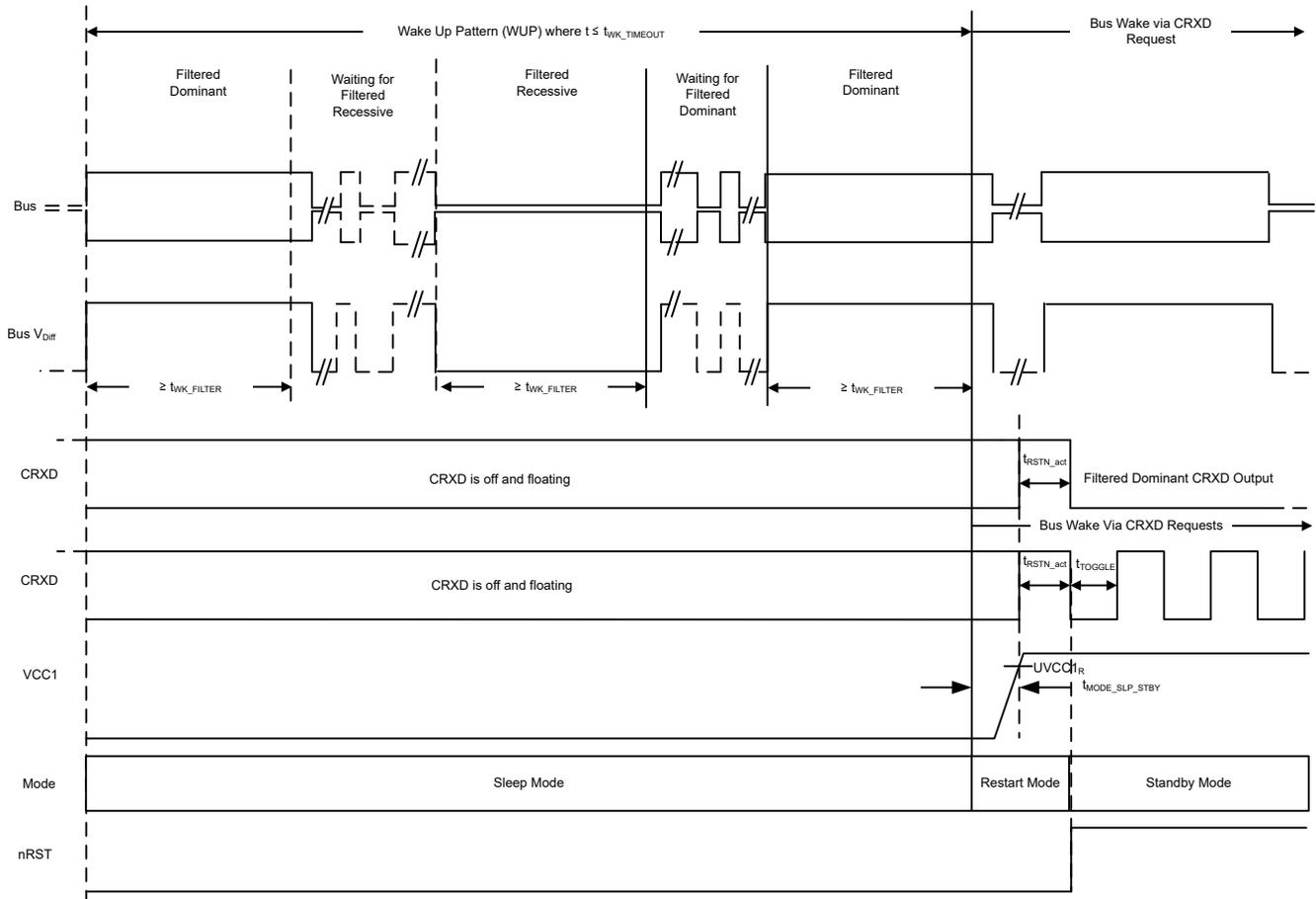
図 8-16. ウェークアップパターン (WUP) と RXD 要求によるバス ウェーク (BWRR)
