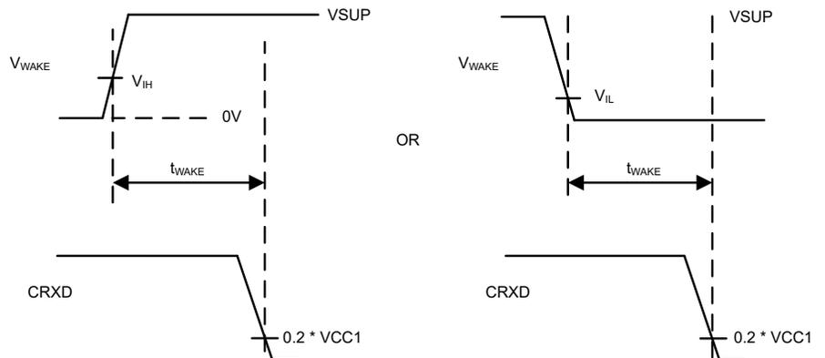
図 7-9. RXD 出力監視中の  $t_{WAKE}$
