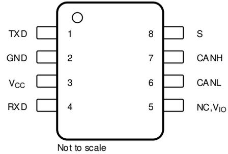
図 4-2. D パッケージ、8 ピン SOIC
