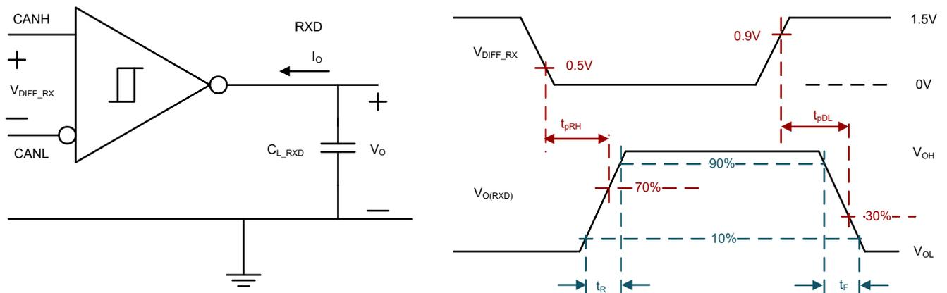
図 6-3. レシーバのテスト回路と測定
