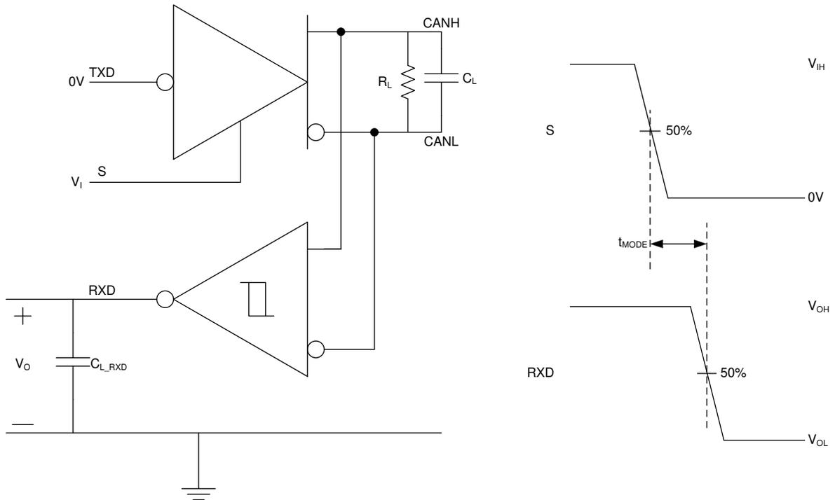
図 6-5.  $t_{MODE}$  テスト回路と測定
